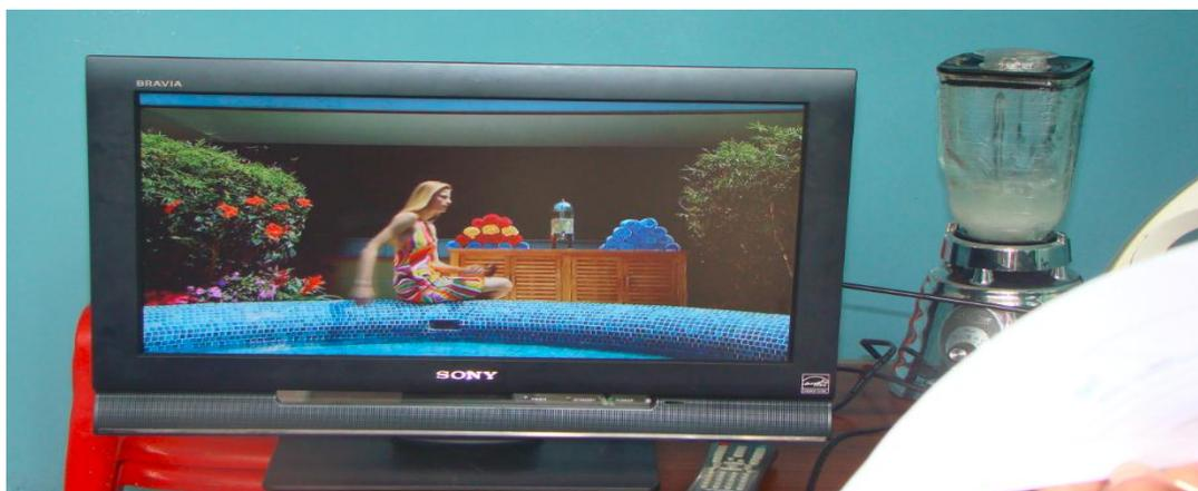
Figura 43. Señal de recepción de TDT, sometida a influencia de ruido eléctrico
