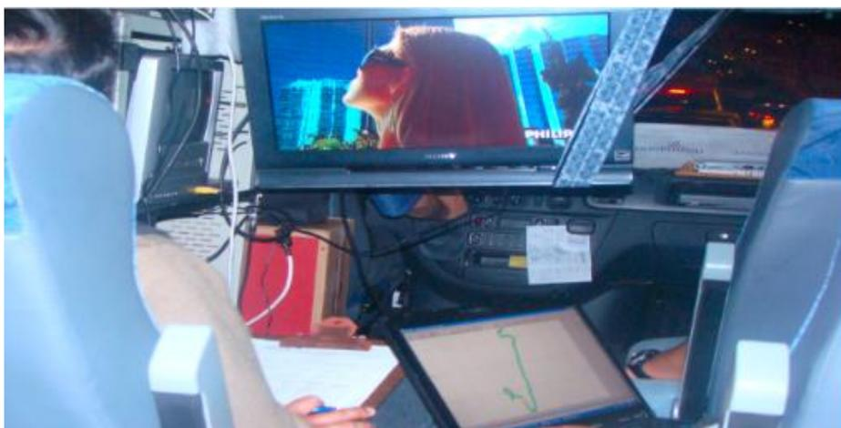
Figura 51. Pruebas de TDT modo móvil. El televisor al interior del vehículo muestra una señal de uno de los estándares en HD
