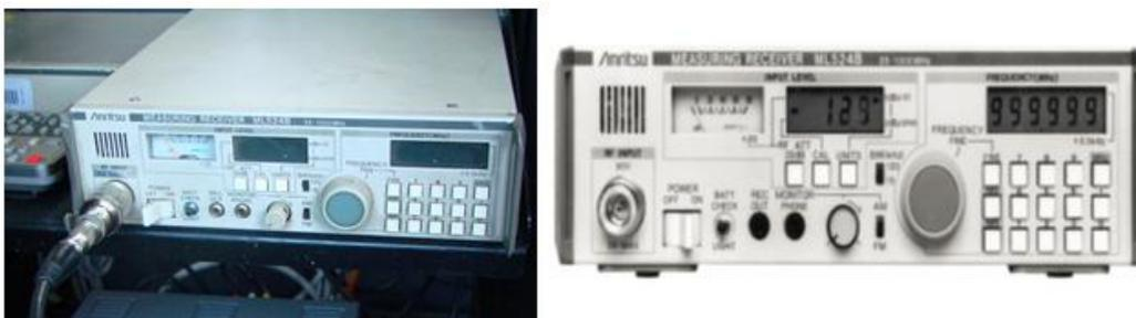
Figura 36. Medidor de intensidad de campo marca Anritsu ML524B
