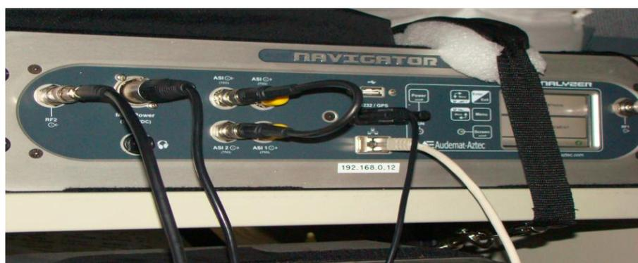
Figura 54. Panel frontal del equipo NAVIGATOR de la empresa Audemat, mediante el cual se realizaron mediciones técnicas de nivel, BER y MER
