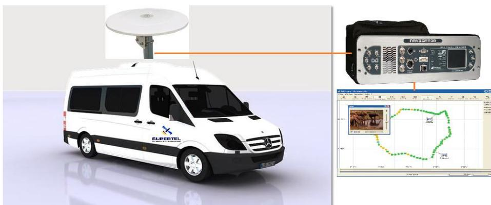
Figura 53. Mediciones de drive test de señales de TDT. Utilización del equipo NAVIGATOR de la empresa Audemat
