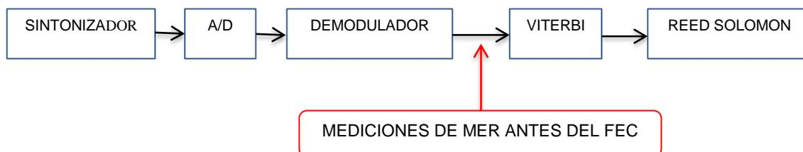
Figura 81. Configuración de medida del MER
