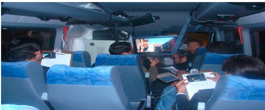
Figura 56. Pruebas de TDT, modo personal con portabilidad. Cada evaluador dispone de un receptor portátil mientras el vehículo se está en movimiento
