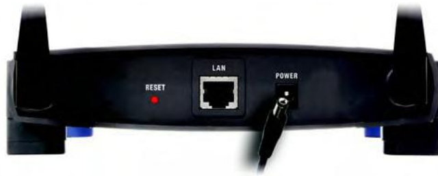
Figura No 3.34. Conexión del Puerto Power
