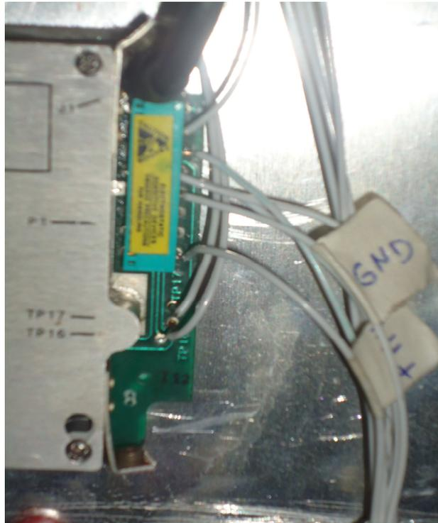
Foto 3.5. Conector de la Tarjeta Marker Beacon
