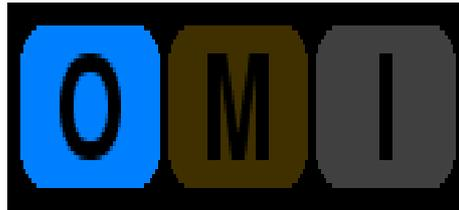
Fig.2.5 Indicador de Radiobaliza exterior
