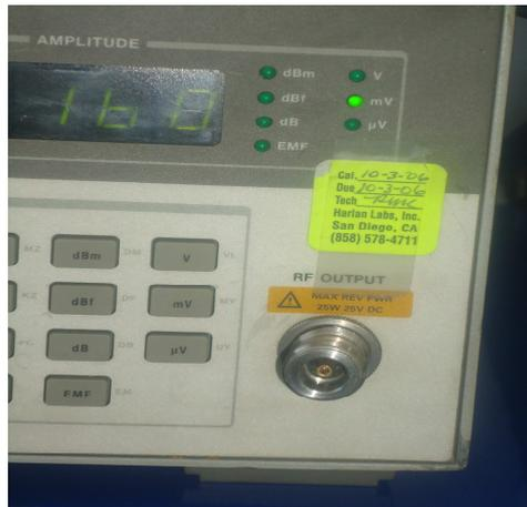
2. Conectar la salida del generador de señales de información a la entrada del generador de RF 8656B
