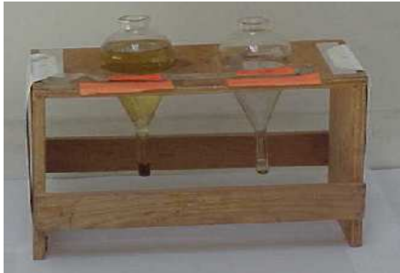
Fig. 2.3. Tubos de decantación de partículas magnéticas
