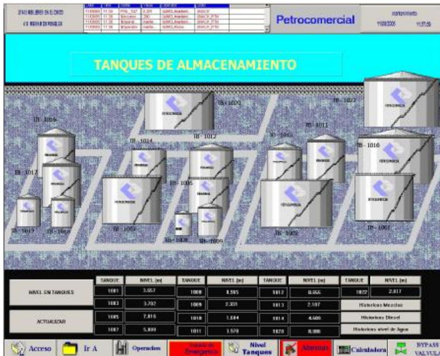
Figura 5.32. Pantalla de los Niveles de los Tanques
