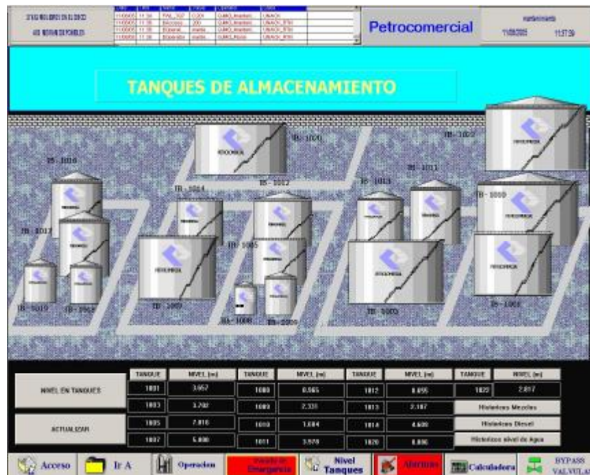
Figura 6.1. Pantalla de los Niveles de los Tanques
