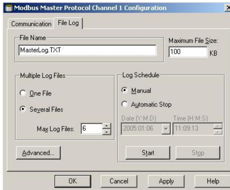
Figura 5.5. Pantalla de configuración del protocolo Modbus Master
