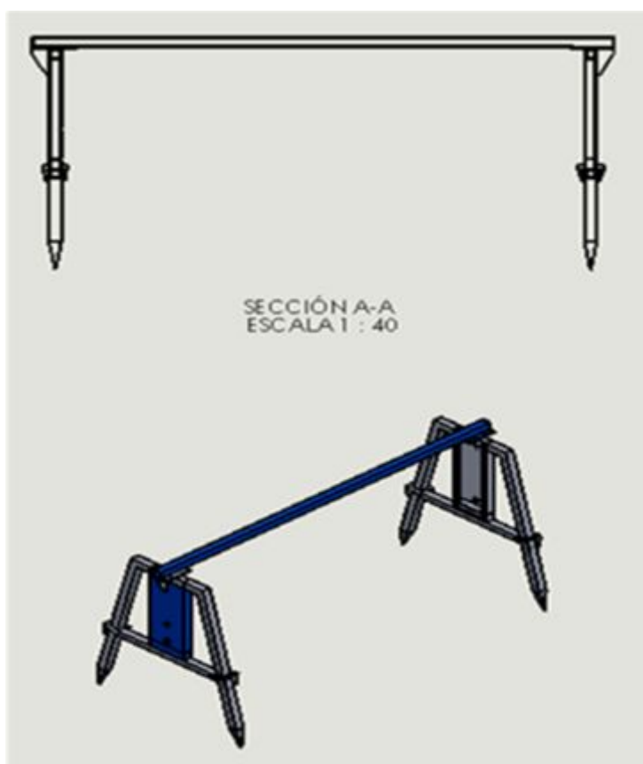
Figura Nº. 23 Pórtico metálico
