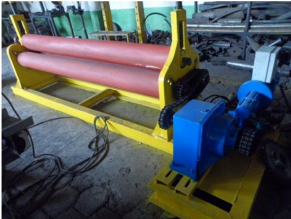
Figura N°. 28 Baroladora para geometrización de álabes
