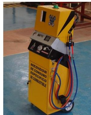
**Figura 1. Medidor de consumo específico de combustible**
