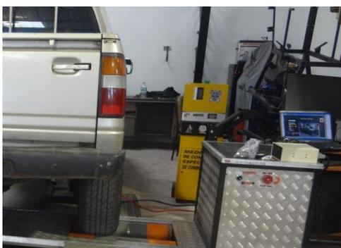
Figura 3. Conexión del equipo al vehículo de prueba
