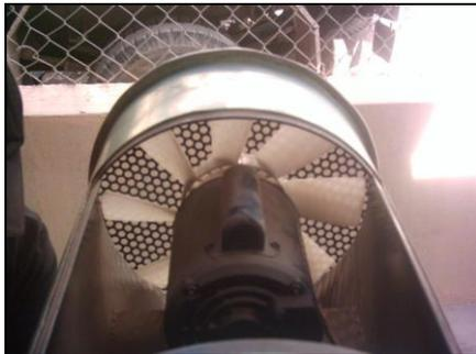
**F 28. Ventilador axial y motor del quemador.**
