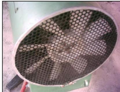
**F 27. Ventilador axial del quemador.**
