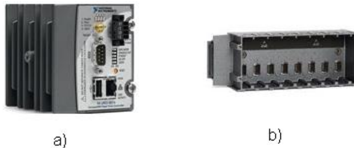
Figura 2.1 Compact Rio: a) Módulo, b) Chasis.
