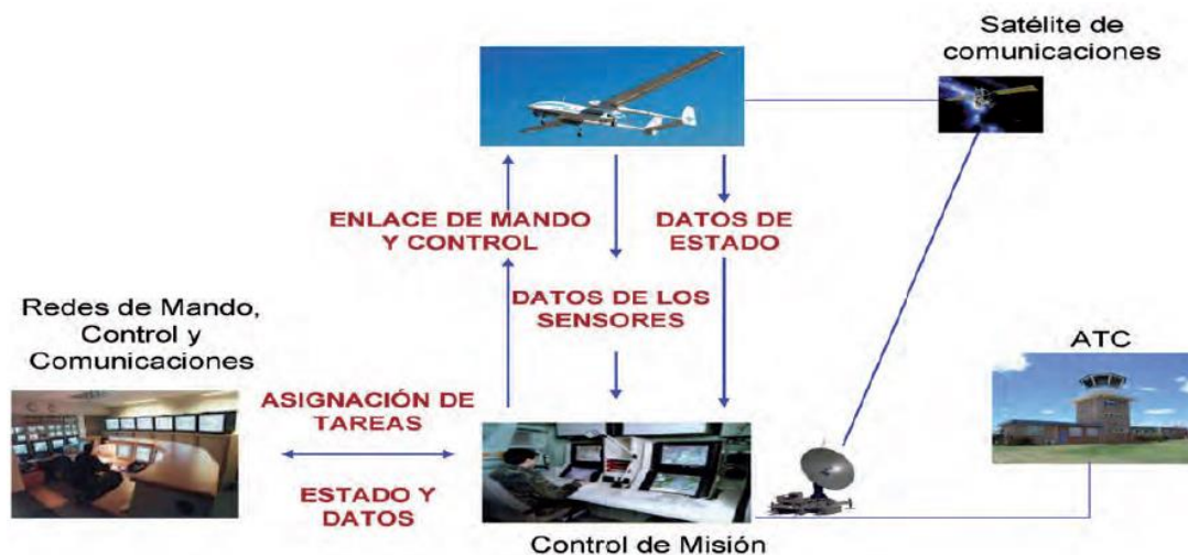
Figura 1.3 Enlaces de voz y datos del UAS
