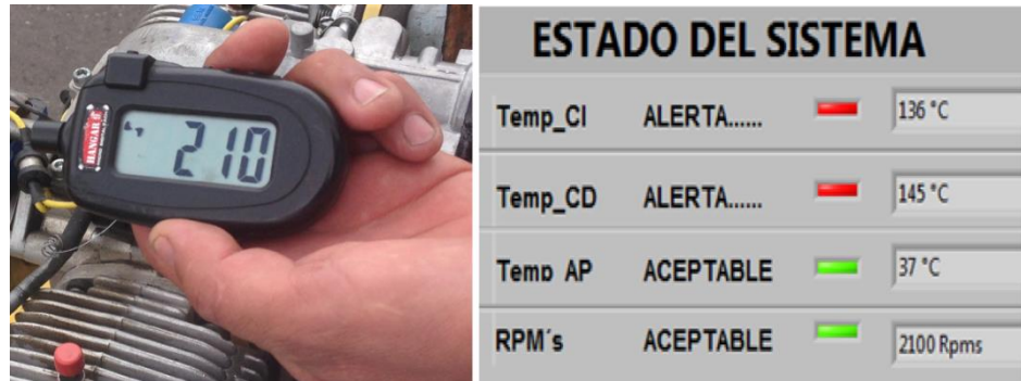
Figura 3.3 Comparación entre el medidor de rpm y la interfaz
