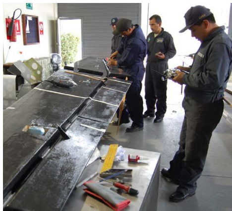
Figura 1.10 Montaje de los alerones
