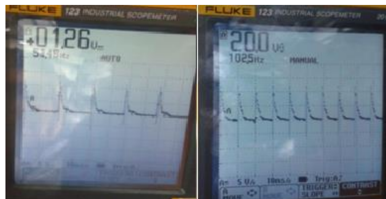
Figura 2.26 Forma de onda y voltaje pico de la señal de salida del motor para la medición de Rpm
