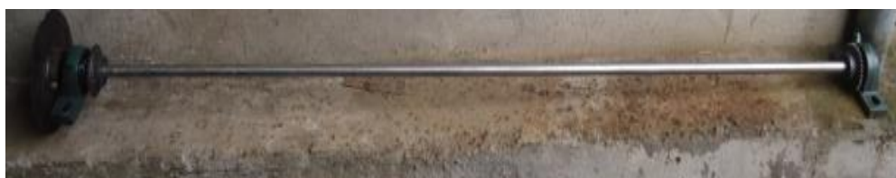
Figura 5.7.: Catalinas para el movimiento longitudinal.
