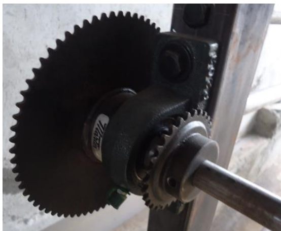
Figura 5.8.: Montaje catalina - chumacera a la estructura.
