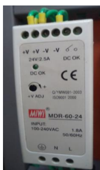
Figura 4.5.: Fuente de corriente continua para el PLC.
