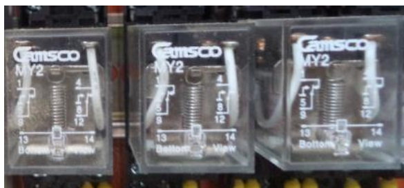
Figura 4.3.: Relés auxiliares con base incluida.
