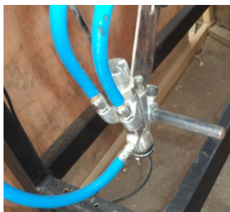
Figura 5.18.: Pistola automática con tubería neumática de 12 mm.
