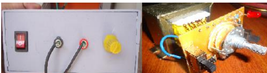
Figura 4.6.: Fuente de corriente continua para el motor.
