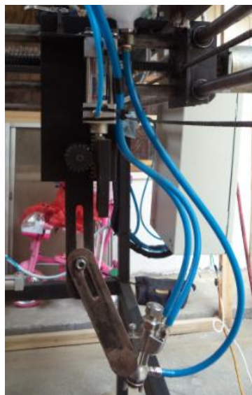
Figura 5.11.: Cilindro neumático - cremallera.
