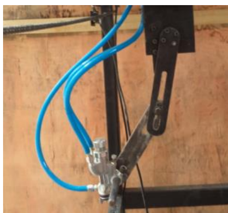
Figura 5.13.: Soporte para la pistola de pintura.
