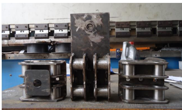
Figura 5.3.: Carros trasversales y longitudinal.
