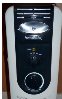
Figura 5.31.: Calefactor con el control de temperatura.
