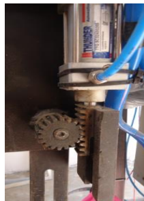
Figura 5.43.: Actuador de giro de la pistola.
