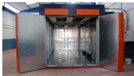
Figura 2.2.: Cabinas murales presurizadas.
