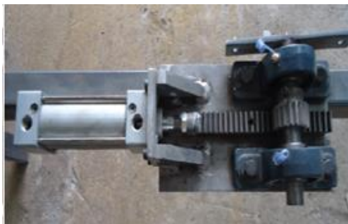
Figura 5.2.: Cilindro de giro de la puerta.
