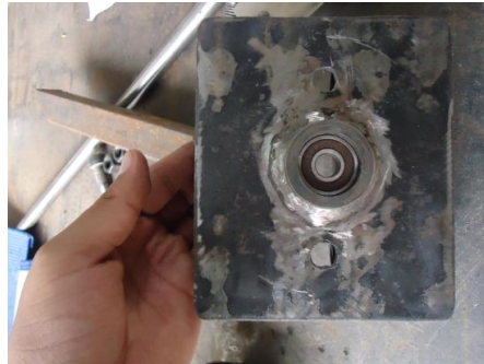
Figura 5.10.: Rodamiento 6000 sobre el carro transversal.
