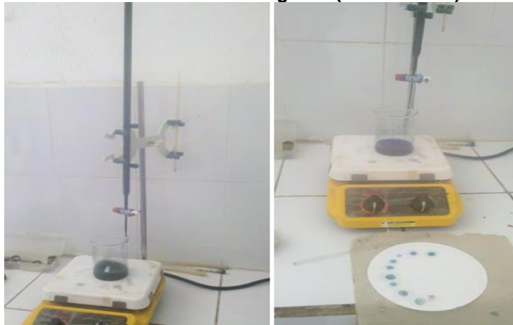
Fig. 16: Ensayo de Azul de Metileno
