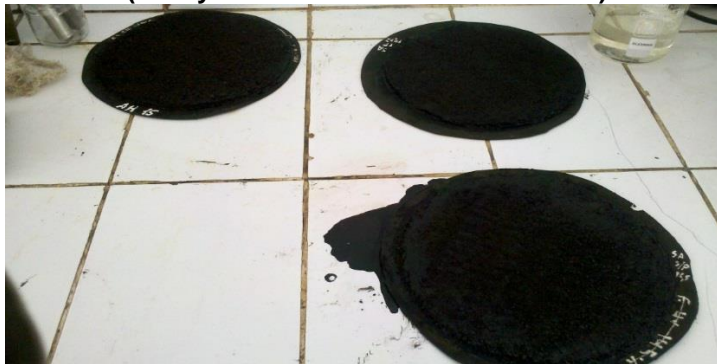
Fig. 26: Moldes de Micropavimento para el Ensayo de Abrasión
