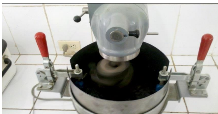
Fig. 27: Ensayo de Abrasión en Húmedo del Micropavimento
