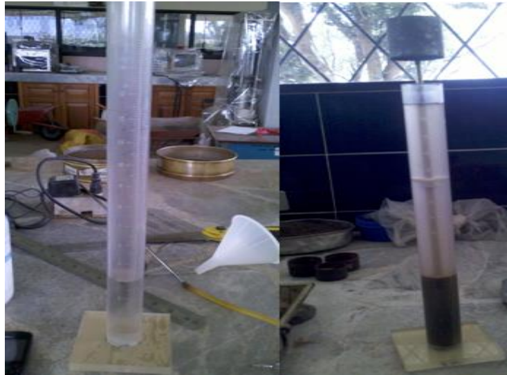
Fig. 15: Ensayo de Equivalente de Arena
