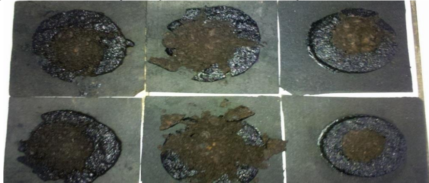
Fig. 23: Muestras ensayadas por Cohesión de Micropavimento a los 60 minutos
