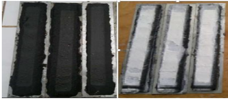
Fig. 29: Moldes después del Ensayo de Rueda Cargada
