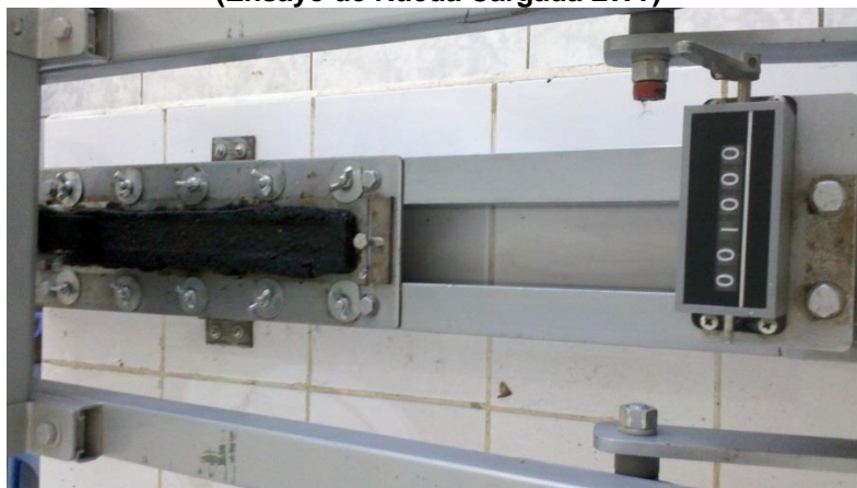
Fig. 28: Ensayo de Rueda Cargada para Micropavimento
