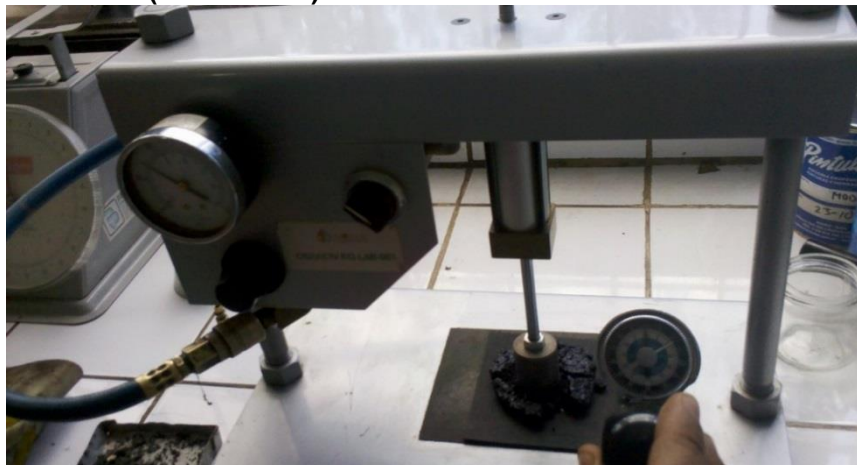
Fig. 21: Ensayo de Cohesión al Micropavimento
