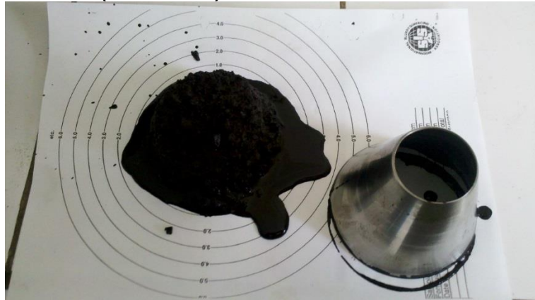
Fig. 19: Ensayo de Consistencia de la Mezcla Asfáltica
