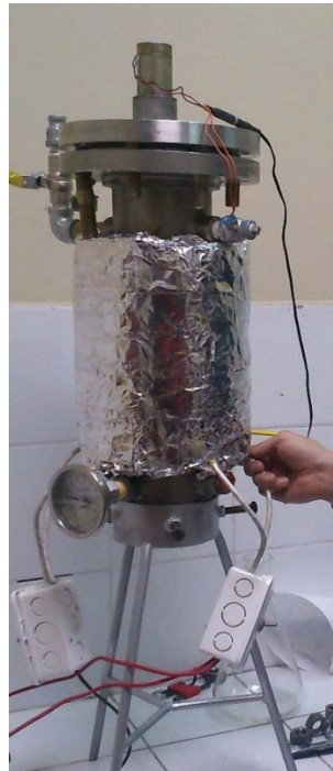
Figura 49: Fotografía Prueba de Calentamiento Tanque Carboxi Este tanque alcanzó la temperatura de 92°C en 24 minutos y para lograr
