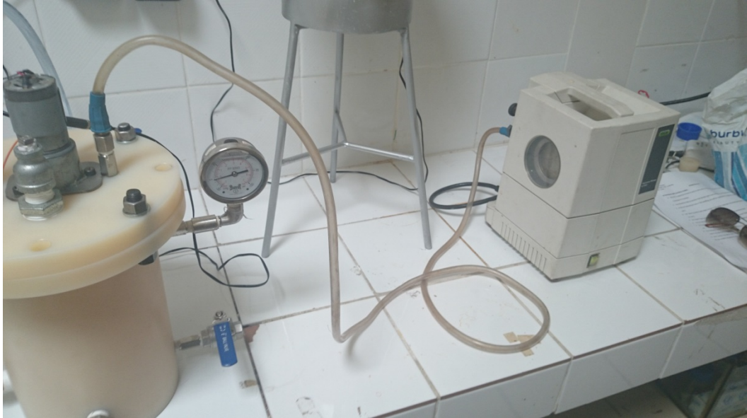
Figura 50: Fotografía de generación de vacío en Reactor
