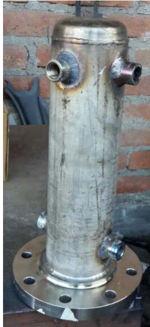
Figura 42: Fotografía de Tanque de Carboxi al finalizar proceso de fabricación
