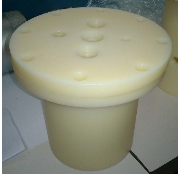
Figura 41: Fotografía tanque de Borhidruro al finalizar proceso de fabricación
