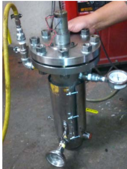
Figura 46: Fotografía Prueba Neumática Tanque Carboxi
