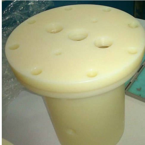
Figura 43: Fotografía de Reactor al finalizar proceso de fabricación
