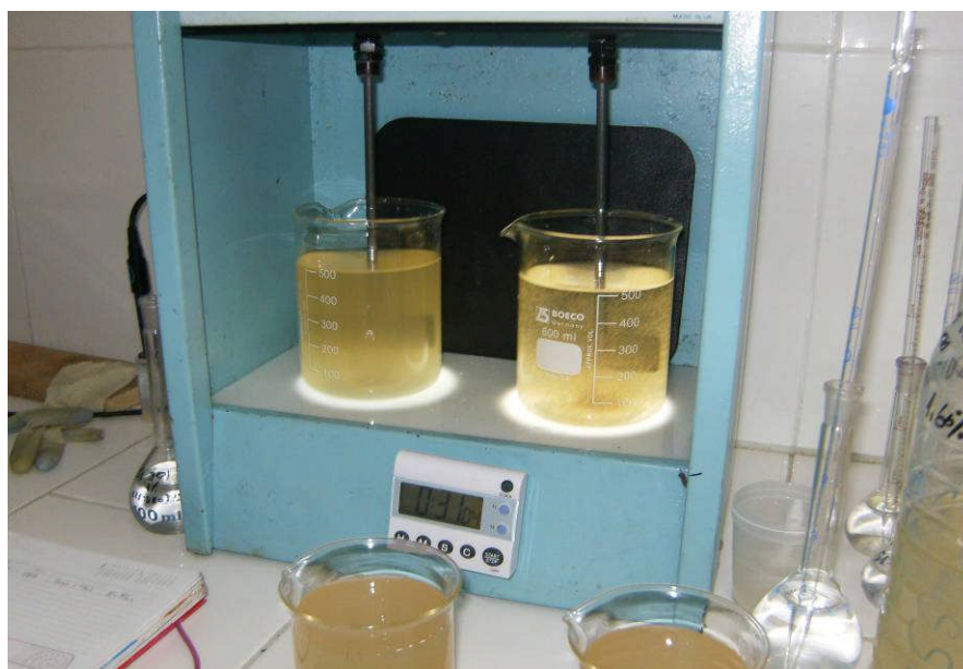
Fotografía: 7.2 del Anexo 18. Ensayo de Jarras 100 rpm Fuente: autor 2008
