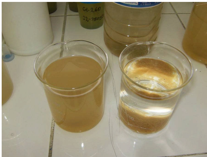
Fotografía: 7.5 del Anexo 18. Ensayo de Jarras Sedimentando 5 min-A. Fuente: autor 2008
