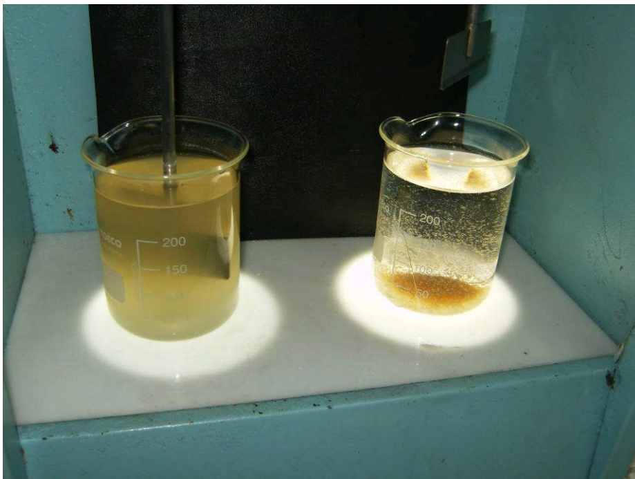
Fotografía: 7.3 del Anexo 18. Ensayo de Jarras Sedimentando 1 min. Fuente: autor 2008
