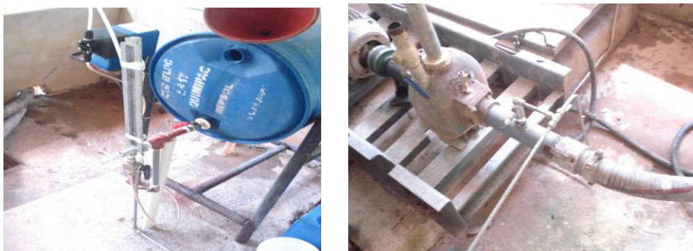
Fotografías. 4.16. Izq. y 4.17. Der. Sistema de Coagulación-Floculación Fuente: autor 2007
