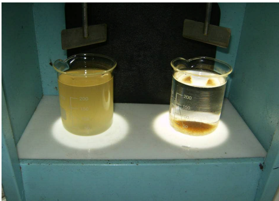
Fotografía: 7.4 del Anexo 18. Ensayo de Jarras Sedimentando 3 min. Fuente: autor 2008
