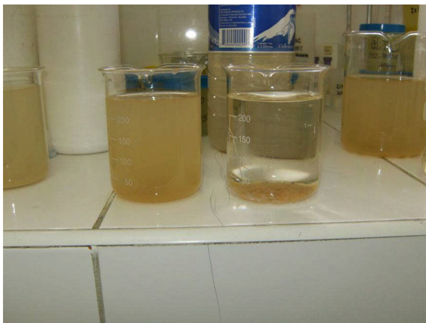
Fotografía: 7.6 del Anexo 18. Ensayo de Jarras Sedimentando 5 min-B. Fuente: autor 2008
