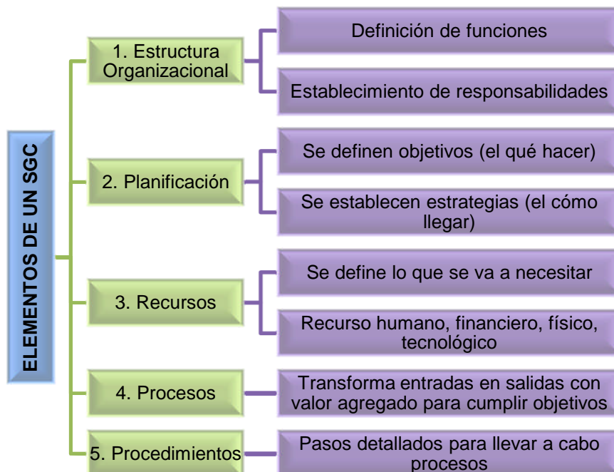
Figura 23. Elementos de un Sistema de Gestión de la calidad - SGC Adaptado de: Tesis UTPL, Torres, R., 2012.
