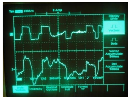
Fig. 7: Medición del Sistema de mejoramiento de calidad auditiva para 70 dB.
