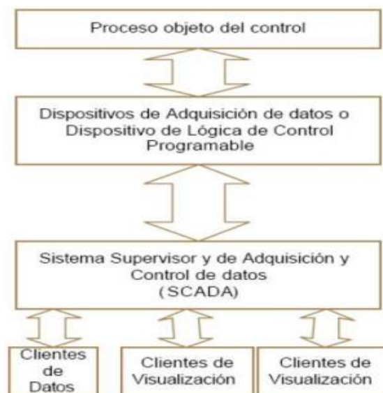
Figura 1.1 Esquema de un sistema SCADA[2]
