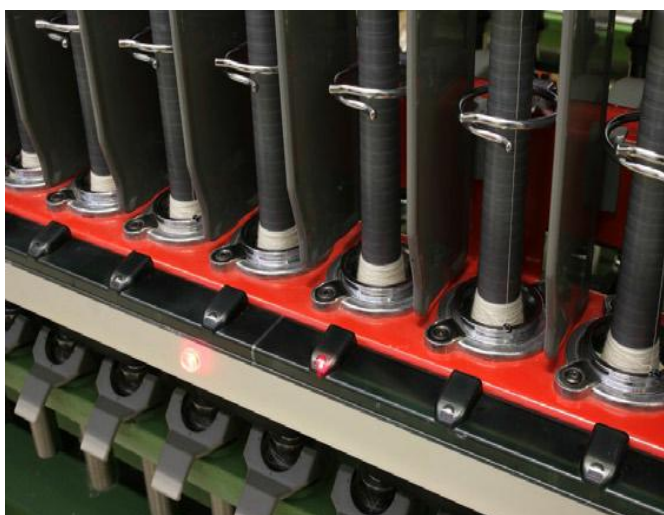
Figura 1.18: Control individual sobre los husos.
