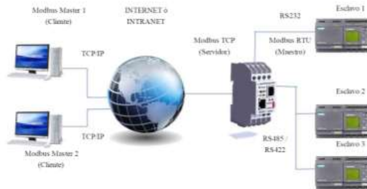
Figura 1.19: Arquitectura Modbus/TCP. Maestros en el lado TCP
