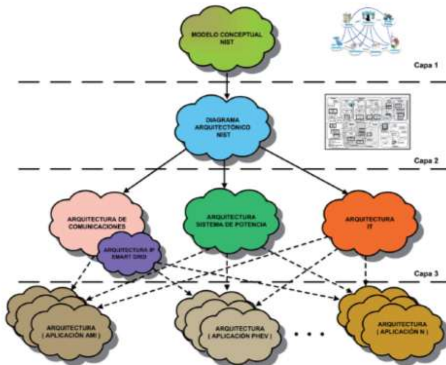
Figura 1.9: Modelo de cuatro niveles para la implantación de Smart Grid.
