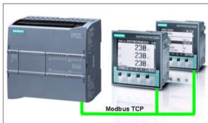
Figura 2.3: Comunicación Modbus TCP-IP Sentron PAC 3200
