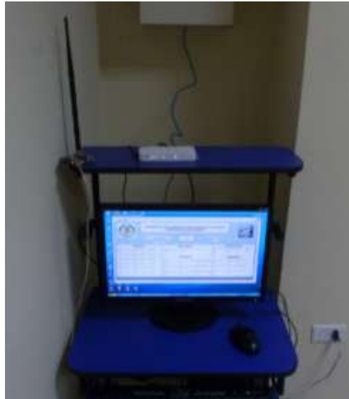
Figura 3.10: Módulo coordinador del sistema de monitoreo de consumo de agua
