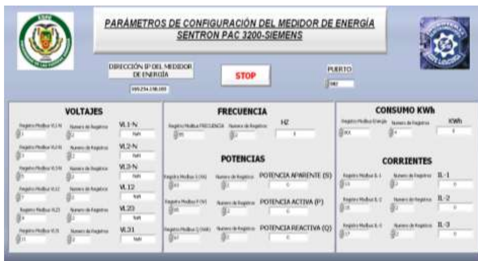
Figura 2.13: Panel frontal de los parámetros de configuración del Sentron PAC 3200.
