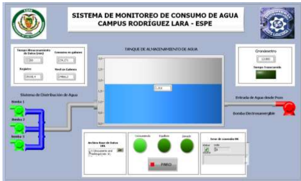
Figura 2.23: Panel frontal o HMI del sistema de monitoreo de consumo de agua.
