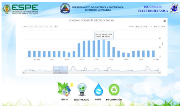
Fig. 18 Página web del sistema de monitoreo de consumo de energía eléctrica en kWh
