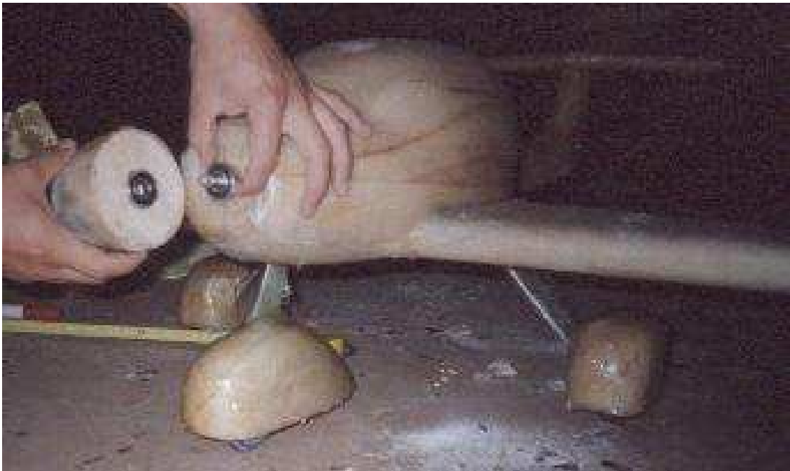
Figura 3.1 Formación de agujero para inserción de cojinete
