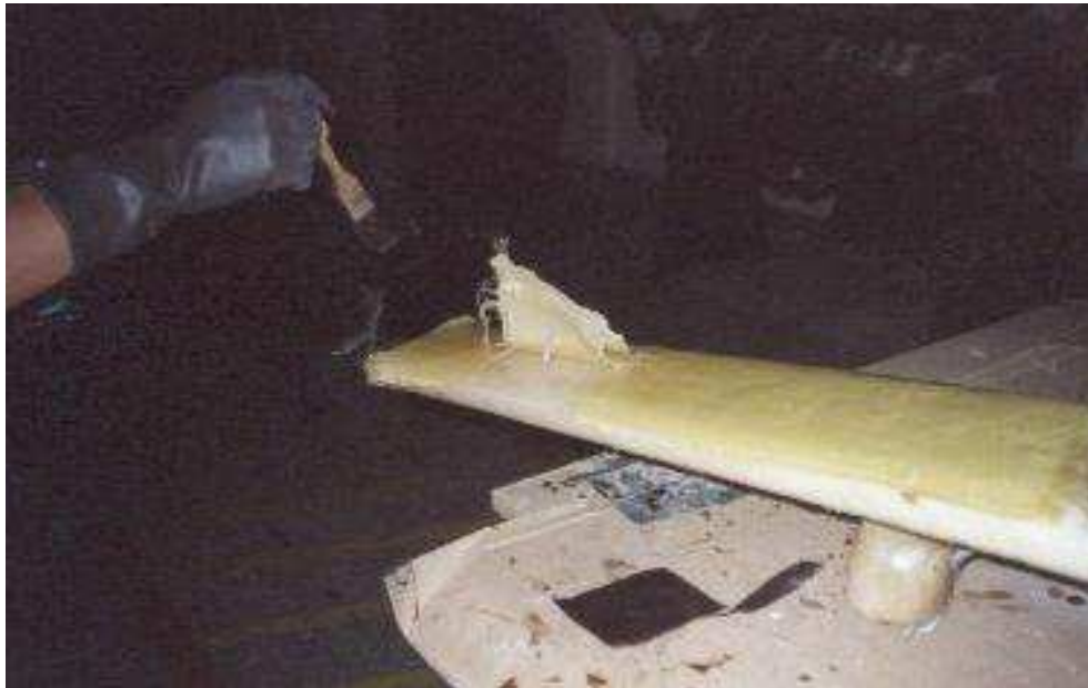
Figura 3.13 Aplicación de matriz sobre capa de fibra de carbono
