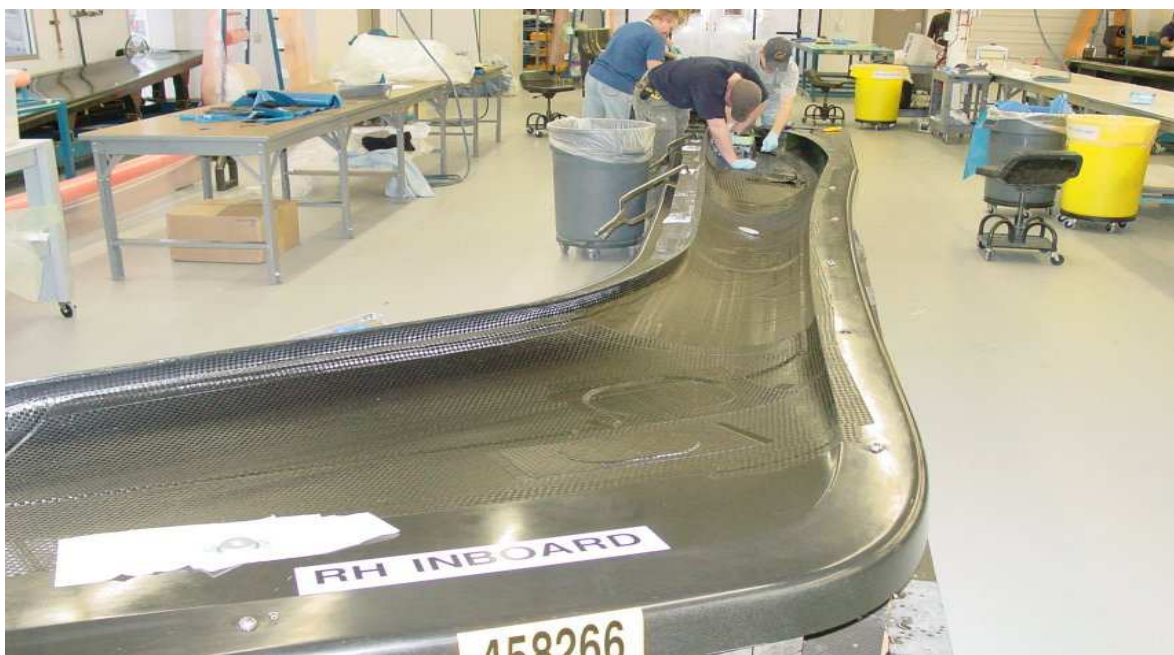
Figura 1.3 Fabricación de una estructura con materiales compuestos
