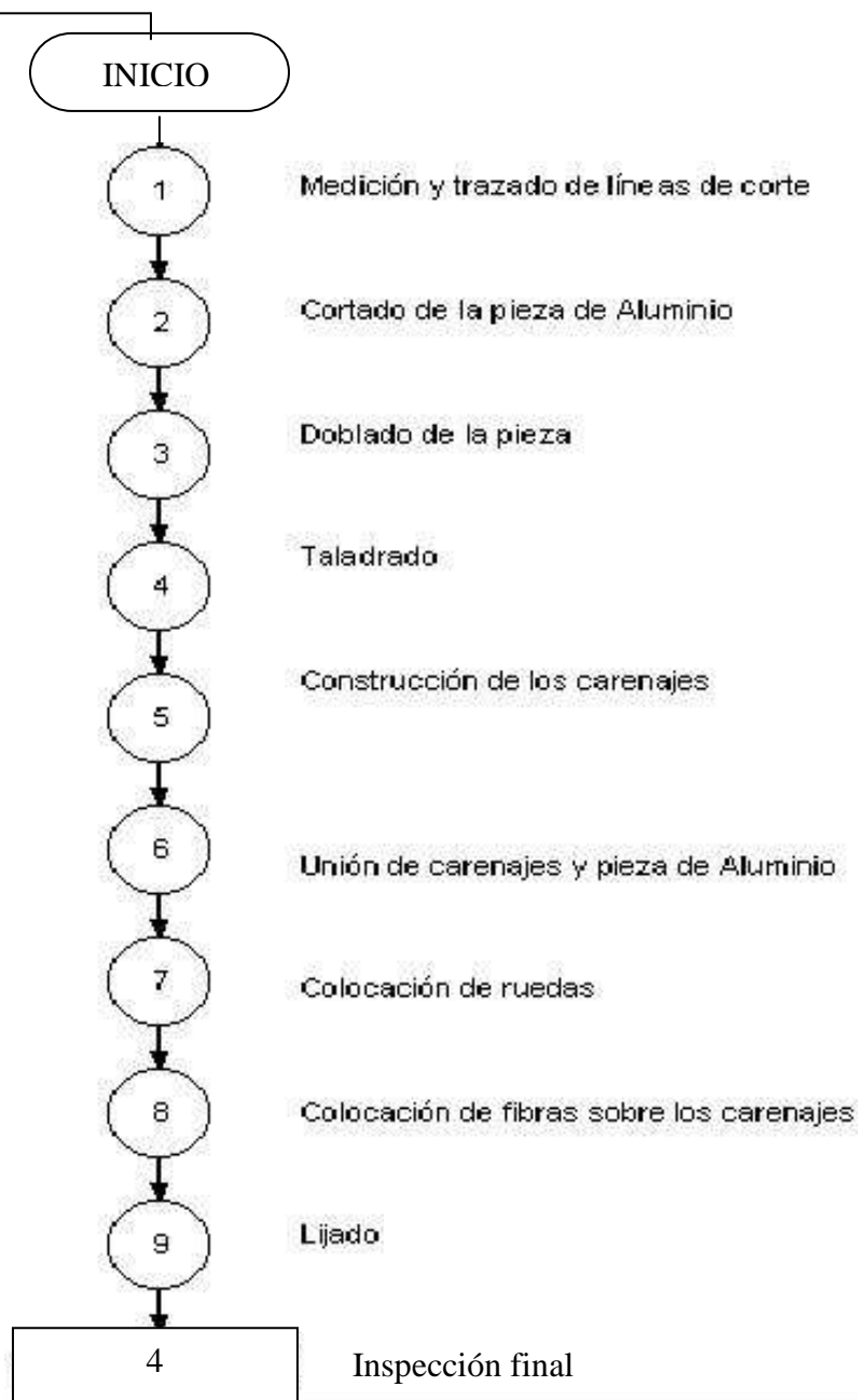
Figura 3.6 Proceso de construcción del tren de aterrizaje principal
