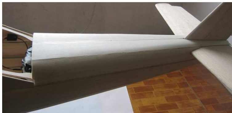
Foto 3.28. Revestimiento de la Parte Superior del Fuselaje
