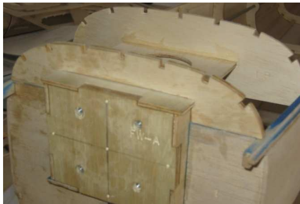
Foto 3.22. Marco Superior del Fuselaje
