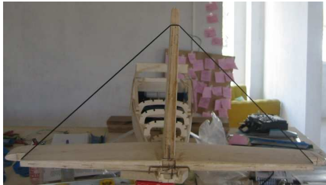
Foto 3.27. Comprobación de las distancias desde las puntas de los Estabilizadores
