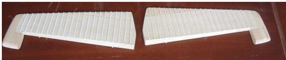
Foto 3.35. Corrugaciones de las Superficies de Control
