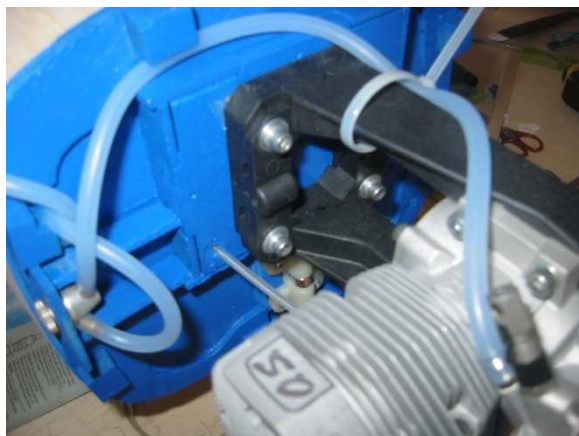
Foto 3.26. Instalación del Tanque y Líneas de Combustible
