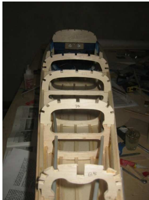
Foto 3.21. Instalación de Las Varillas de Empuje
