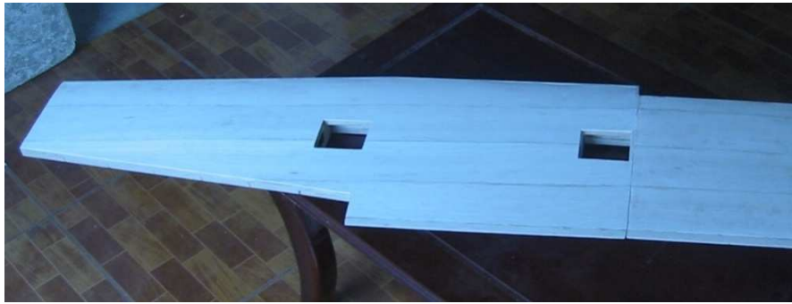
Foto 3.11. Revestimiento de la Parte Inferior del Ala
