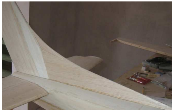
Foto 3.29. Aleta Dorsal del Estabilizador
