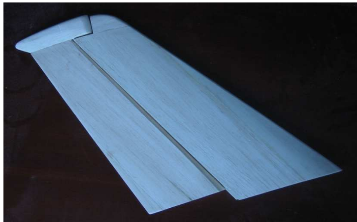
Foto 3.6. Estabilizador Vertical y Timón de Dirección Terminado
