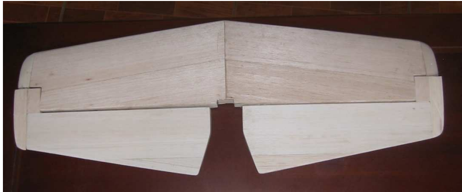
Foto 3.2. Terminado de los Elevadores
