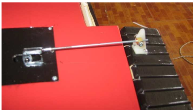
Foto 3.37. Chequeo de Servos y Varillas de Empuje
