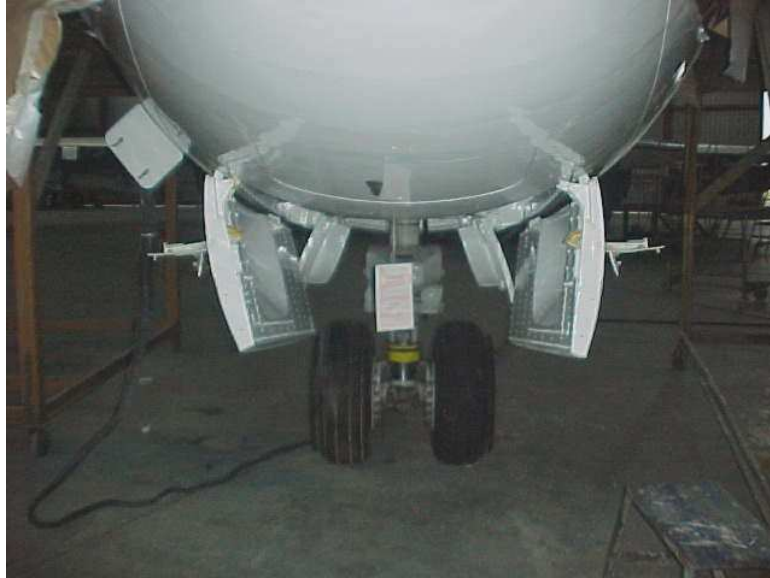
Figura 1.10. Compuertas del tren de nariz
