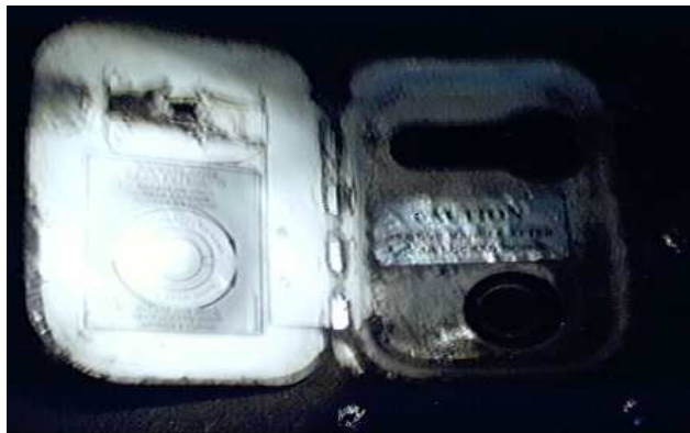
Figura 1.13. Manivela de extensión manual del tren de nariz
