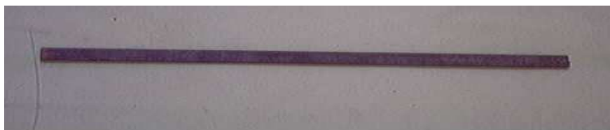
Figura 3.2. Platina de hierro de \frac{1}{2} " * \frac{1}{8} "
