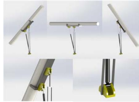
Figura 6. Propuesta del mecanismo de giro del módulo (Elaboración propia).
