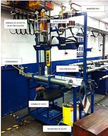
La estación Xceed, a pesar de que el principio de funcionamiento es el mismo que la estación para TeleScope e ImPulse, esta se diferencia debido a que uno de los recipientes está dentro del otro.
