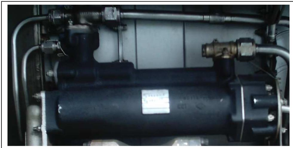
Figura. 1.15. Intercambiador de calor aceite – combustible.
