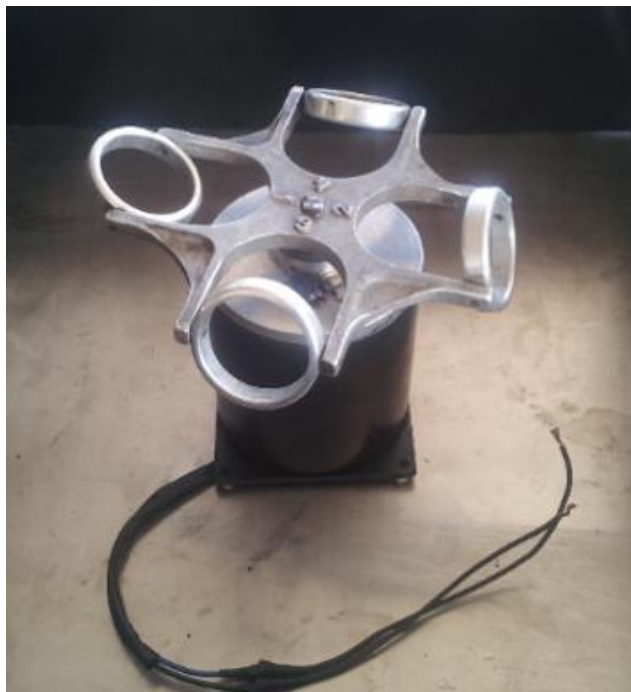
Figura 27. Centrífuga Robinson 820A, sin su cubierta.
