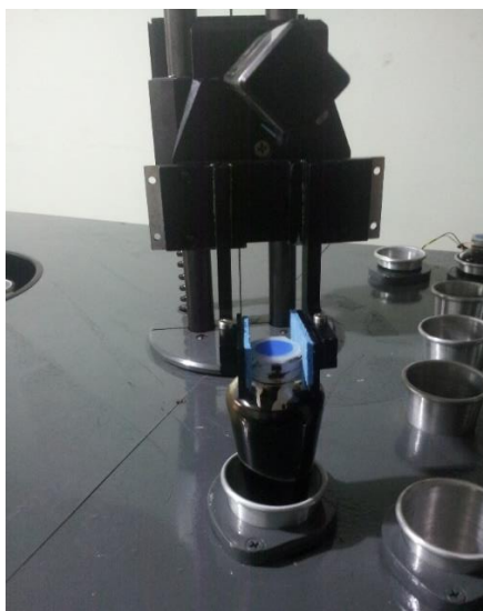
Figura 80. Ubicación de probeta en la zona de precalentamiento.
