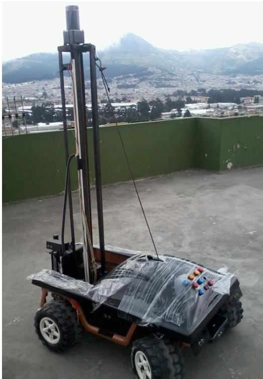
La máquina enfardadora, en su velocidad más alta, puede envolver una carga de 75cm ubicada sobre un euro-palé (1200x800 mm) en un minuto con 32 segundos en ciclo único; y en 2 minutos con 65 segundos en ciclo completo.
