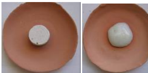
Figura 1.5: Botón de material para esmalte antes y después de su cocción.
