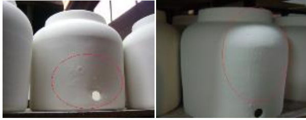
Figura 4.8: Dispensadores esmaltados con fallas superficiales
