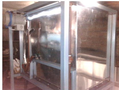
Figura 3.6: Cubierta de tol instalada en la estructura.
