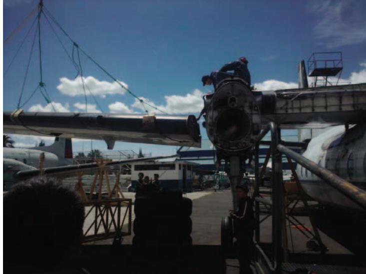
Figura 3.18: utilización de cabos para estabilizar el ala Fuente: Fernando Caicedo
