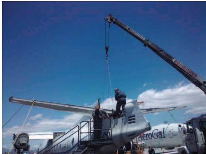
Figura 3.22: Elevación de eslinga para sostener el estabilizador Fuente: Fernando Caicedo
