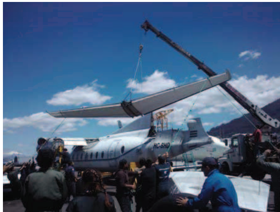
Figura 3.24: Descenso del estabilizador horizontal utilizando eslinga y grúa Fuente: Fernando Caicedo
