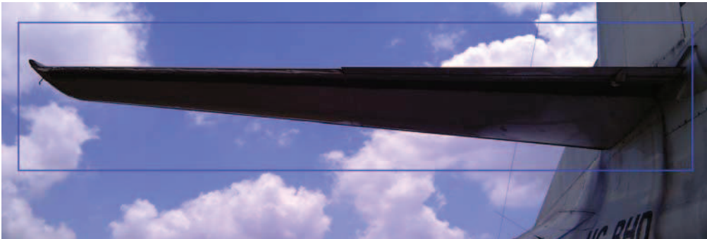
Estabilizador izquierdo que será desmontado
