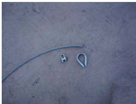
Figura 3.29: Cable con guardacabos y grapas Fuente: Fernando Caicedo
