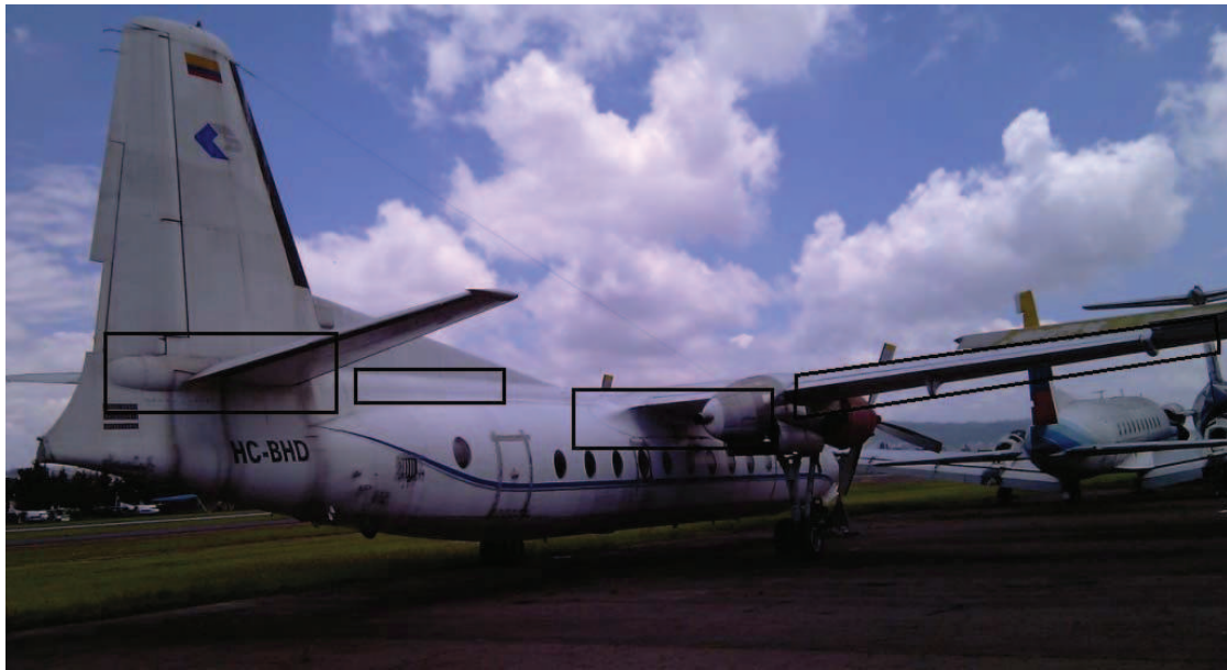
Figura 3.2: Carenajes a ser removidas para el desmontaje Fuente: Fernando Caicedo
