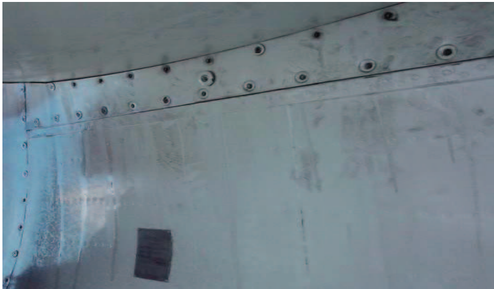
Figura 3.3: Pernos a ser retirados para el desmontaje de los carenajes Fuente: Fernando Caicedo
