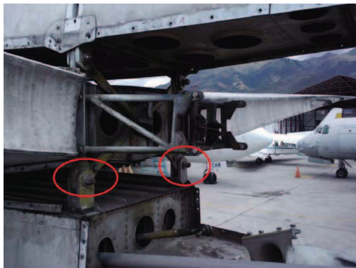
Figura 3.23: Pernos de sujeción del estabilizador al fuselaje Fuente: Fernando Caicedo
