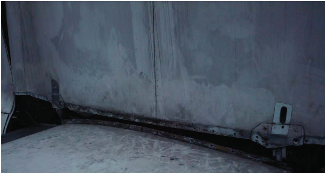
Figuran 3.5: Posición de tapas removidas para el acceso al estabilizador horizontal
