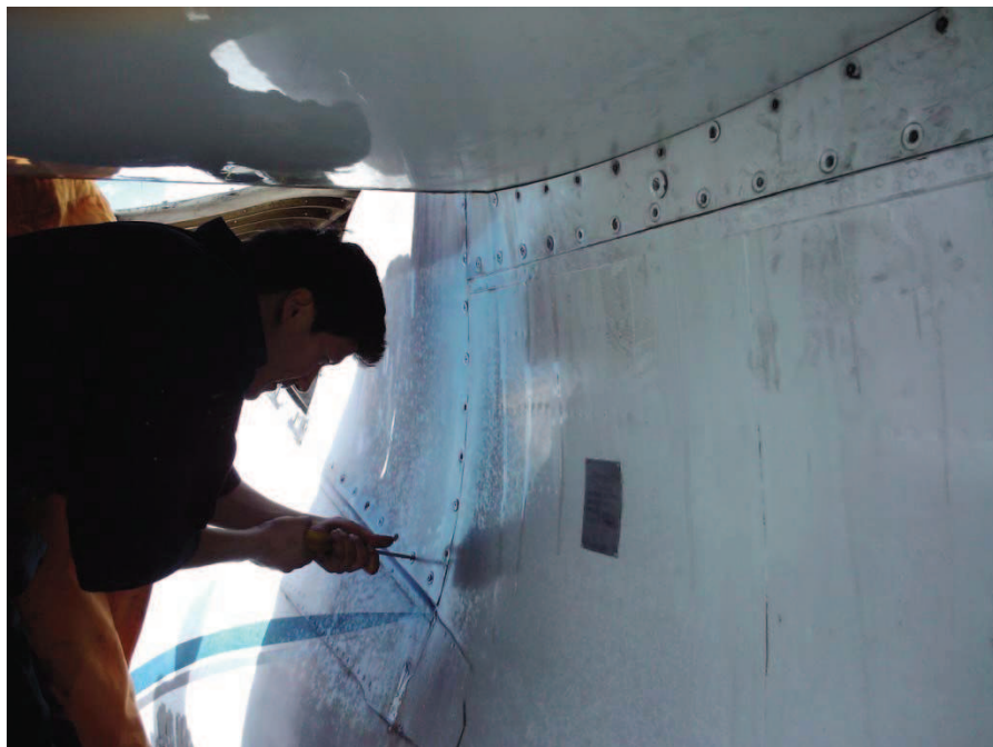
Figura 3.4: Desarmado de carenajes del fuselaje Fuente: Fernando Caicedo
