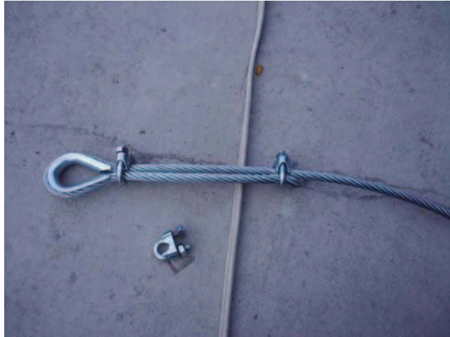
Figura 3.32: Ajuste de cada uno de los extremos de la eslinga Fuente: Fernando Caicedo
