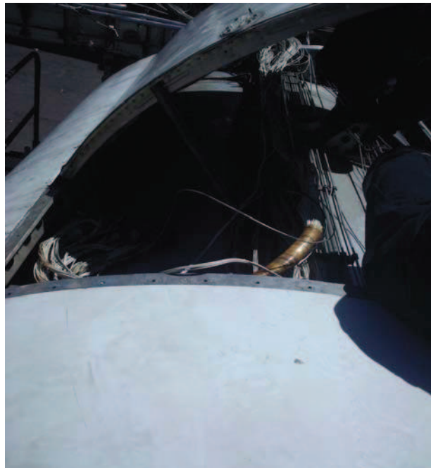
Figura 3.11: Cables eléctricos y tensores removidos del fuselaje y alas.
