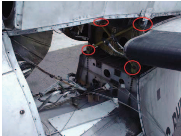
Figura 3.8: Pernos de sujeción del estabilizador al fuselaje Fuente: Fernando Caicedo
