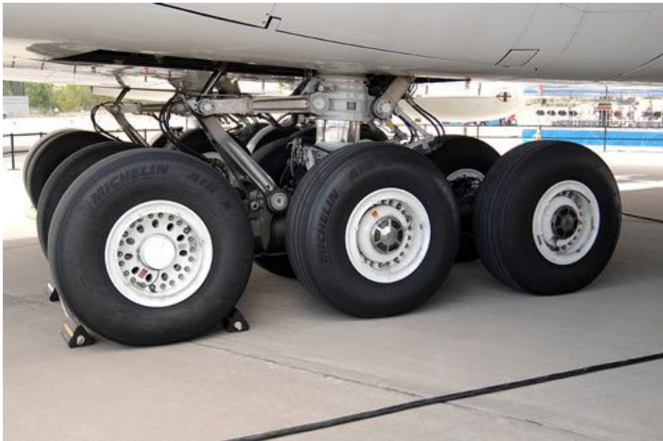
Figura 2.16 Tren de Aterrizaje Principal en el Fuselaje del Airbus A380
