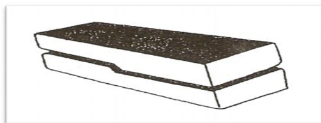
Figura 2. 38 Moldes de empalme
