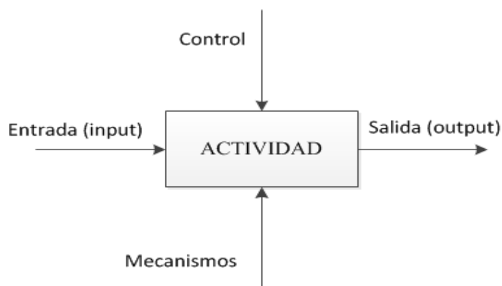
Figura 29: Componentes del diagrama IDEF0
