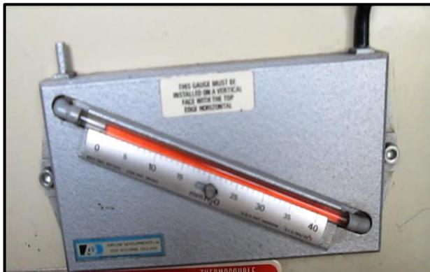
**Figura 2.37:** Medidor de ingreso de aire en mm H<sub>2</sub>O
