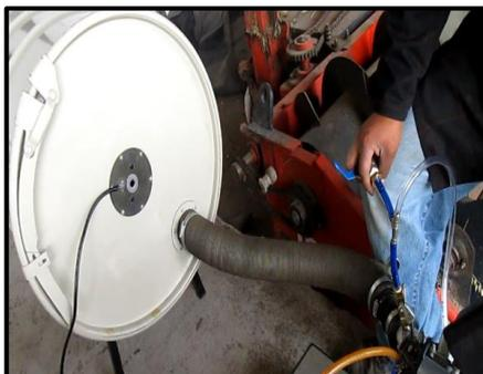
**Figura 2.36:** Tanque y tubo conectado al motor para medir el ingreso de aire
