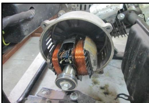
**Figura 5.3:** Rotor del generador LUTOOL
