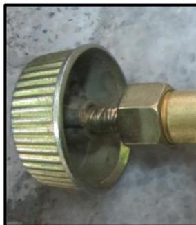
**Figura 3.26:** Regulador de Ingreso de Biogas.
