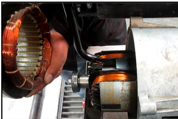
**Figura 5.5:** Rotor y Estator del Generador LUTOOL
