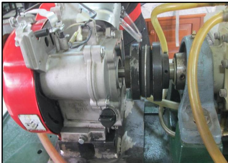
**Figura 2.27:** Unión entre el eje del motor y el eje del dinamómetro
