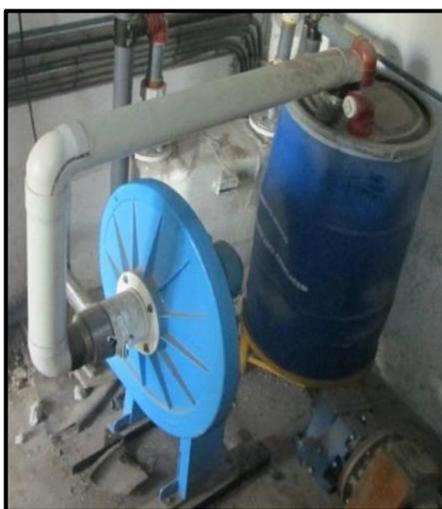
**Figura 3.21:** Conjunto Caudalímetro, Soplador y Filtro H<sub>2</sub>S
