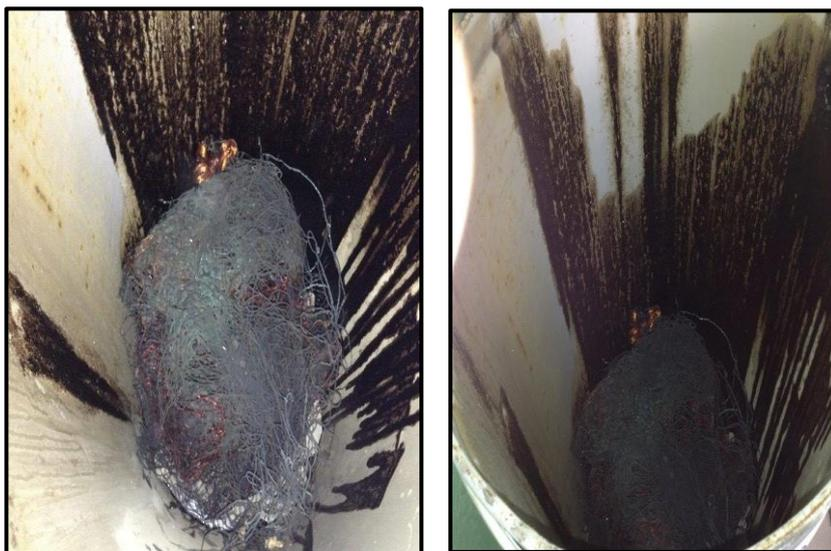
**Figura 3.20:** Estructura interna del filtro de oxidación.
