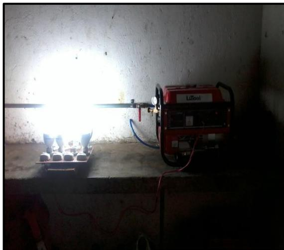
**Figura 5.7:** Motor-Generador LUTOOL funcionando con gasolina
