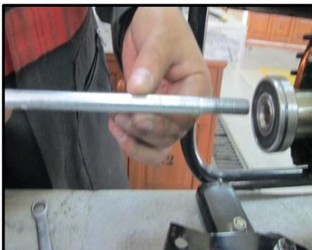
**Figura 5.2:** Perno que une el eje del motor al rotor del generador
