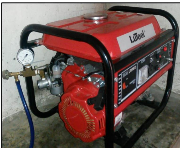
**Figura 5.1:** Generador LUTOOL conectado a la entrada de biogas.
