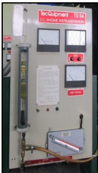
**Figura 2.34:** Elementos para Medir el Consumo de Combustible
