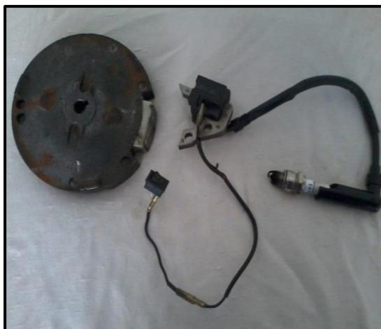
**Figura 3.7:** Componentes del Sistema de Encendido
