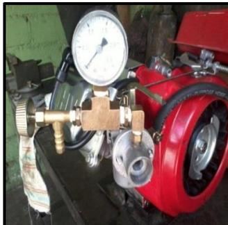
**Figura 3.31:** Instalación del sistema de Alimentación de biogas
