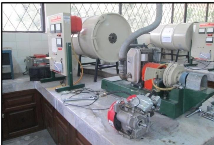
**Figura 2.26:** Banco Dinamométrico Hidráulico.
