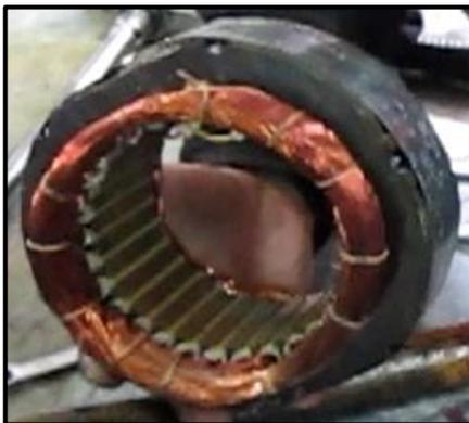
**Figura 5.4:** Estator del Generador LUTOOL
