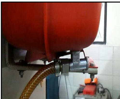
**Figura 2.33:** Llave de Paso y Depósito de Combustible
