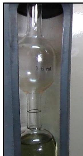
**Figura 2.35:** Probeta de Consumo de combustible de 16 mililitros
