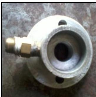
**Figura 3.29:** Entrada de Biogas a la Cámara
