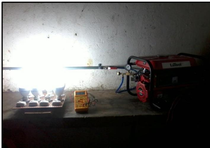
**Figura 5.8:** Motor-Generador LUTOOL funcionando con biogas
