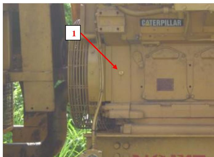
**Fig. 4.10 Punto de medición en el Motor, lado libre.**
