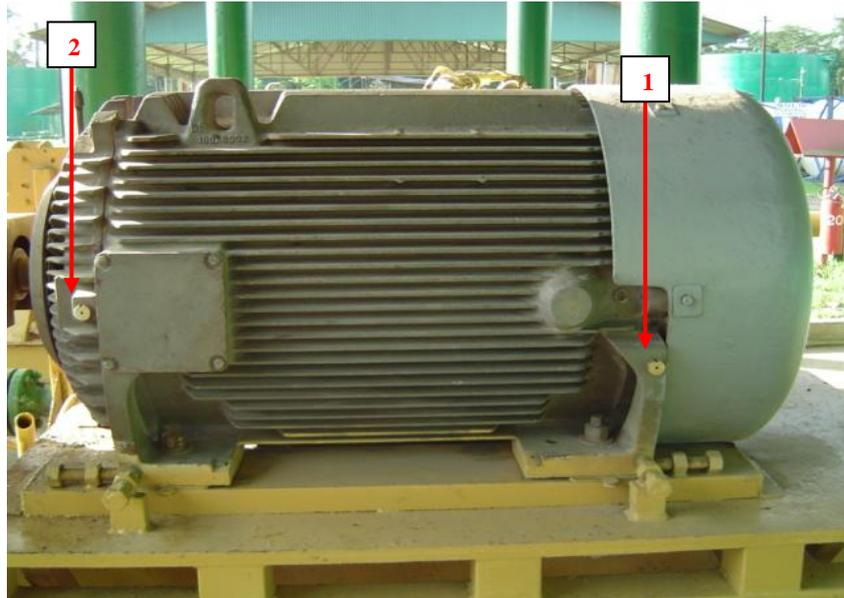
**Fig. 4.5 Puntos de medición en un Motor Eléctrico**
