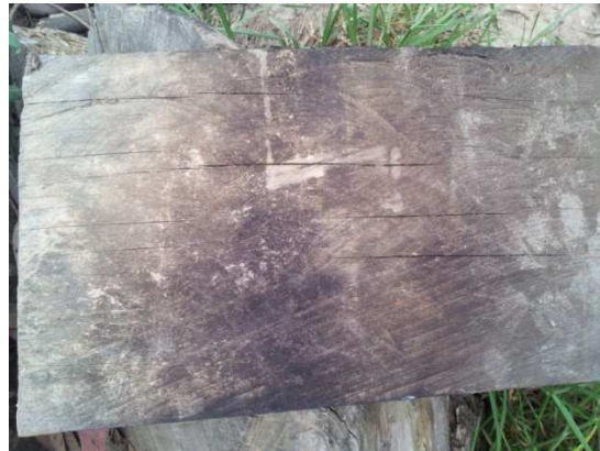
Figura 3.14: Deterioro del producto por secado rápido
