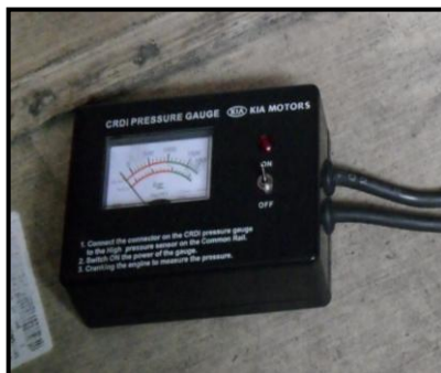
Figura 4. 37. VOLTÍMETRO PARA LECTURA DEL RPS.
