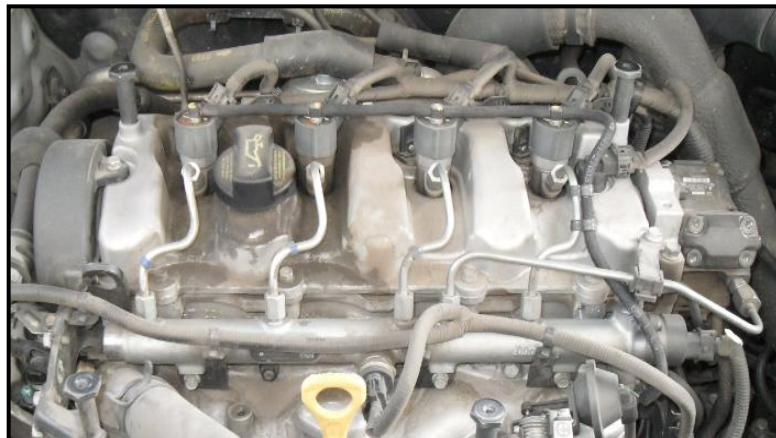
Figura 2. 3. INYECCIÓN DIRECTA POR RIEL COMÚN (CRDI).
