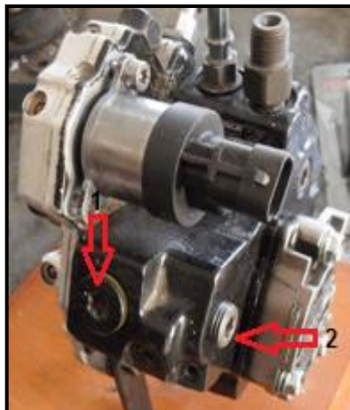
Figura 5. 10. LOCALIZACIÓN DE LA VÁLVULA DE ASPIRACIÓN Y DE SALIDA.
