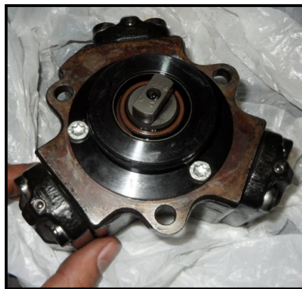
Figura 2. 14. BOMBA DE ALTA PRESIÓN – CP1.
