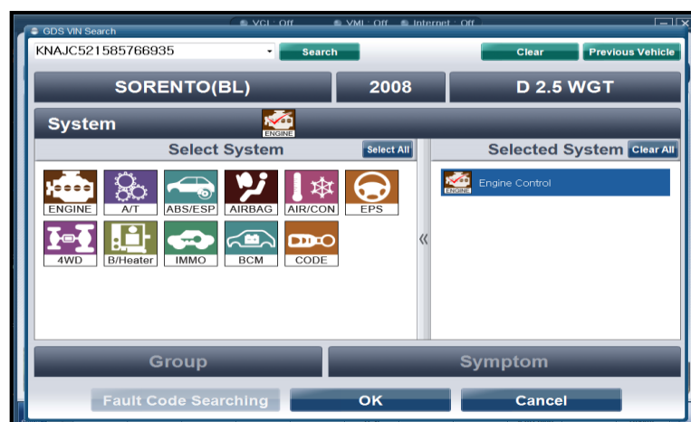
Figura 5. 7. PANTALLA DE SELECCIÓN DE PARÁMETROS DEL VEHÍCULO Y SISTEMA A DIAGNÓSTICAR DEL GDS.
