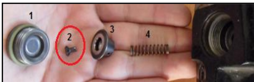
Figura 5. 11. VÁLVULA DE INGRESO DE COMBUSTIBLE HACIA LOS PISTONES DE LA BOMBA DE ALTA PRESIÓN.
