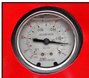
Figura 5. 2. LECTURA DEL MANÓMETRO DE VACÍO.
