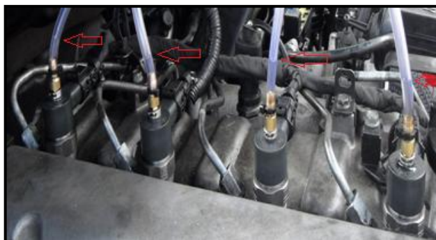
Figura 5. 17. CONEXIÓN DE LAS PROBETAS PARA PRUEBAS DE RETORNO.
