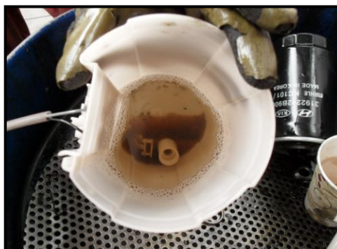
Figura 4. 26. SUCIEDAD EN EL COMBUSTIBLE.
