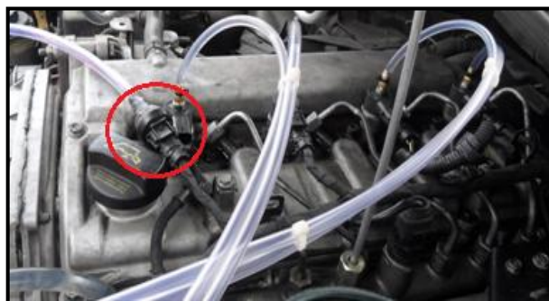
Figura 5. 20. CONEXIÓN DE LA ALIMENTACIÓN ELÉCTRICA DEL INYECTOR EN PRUEBAS.
