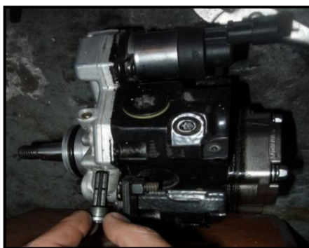
Figura 5. 13. FILTRO INTERNO DE LA BOMBA.
