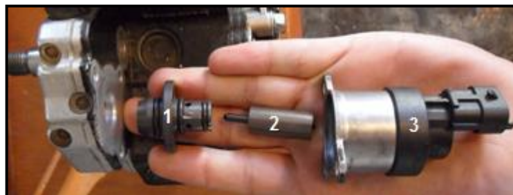
Figura 5. 15. ELEMENTOS DE LA VÁLVULA REGULADORA DE PRESIÓN.
