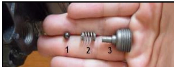
Figura 5. 12. VÁLVULA DE SALIDA DE COMBUSTIBLE HACIA EL RIEL DE ALTA PRESIÓN.
