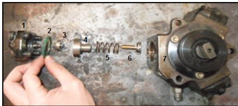
Figura 5. 16. ELEMENTOS DEL CABEZAL - BOMBA CP1.
