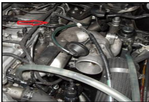
Figura 5. 4. CONEXIÓN DEL EQUIPO ELECTRÓNICO PARA LECTURA DEL RPS DEL CRDI TESTER AL RPS DEL RIEL COMÚN DEL MOTOR.
