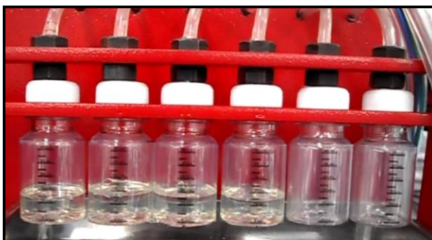
Figura 5. 18. PRUEBA DE RETORNO DE LOS INYECTORES.
