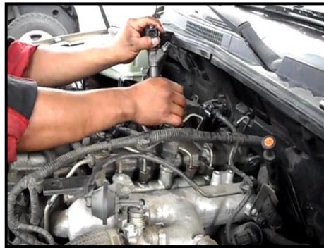
Figura 4. 18. MONTAJE DE LOS INYECTORES EN EL MOTOR.
