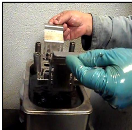
Figura 4. 25. LIMPIEZA POR ULTRASONIDO.
