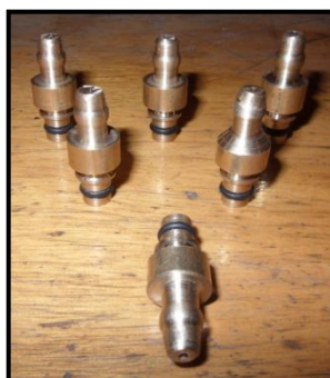
Figura 4. 39. ACOPLER PARA RETORNOS DE LOS INYECTORES.
