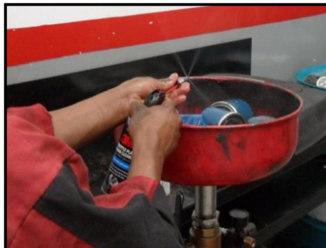
Figura 4. 17. LIMPIEZA INTERNA DE LA TOBERA.
