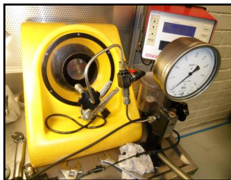
Figura 4. 20. COMPROBADOR MANUAL DE INYECTORES.
