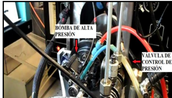
Figura 4. 30. BOMBA DE ALTA PRESIÓN – VÁLVULA DE CONTROL DE PRESIÓN.
