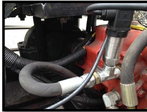
**Figura 4.6 Implementación del sensores de presión aceite hidráulico.**
