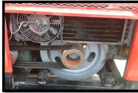
**Figura 2.15: Electroventilador**
