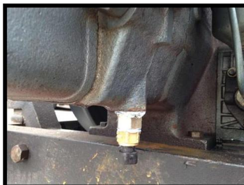
**Figura 4.7 Instalación del sensor de temperatura agua motor.**
