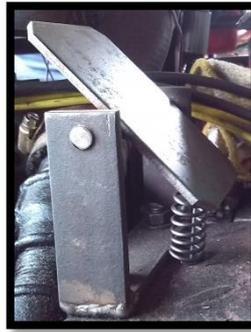
**Figura 4.16 Pedal del acelerador.**
