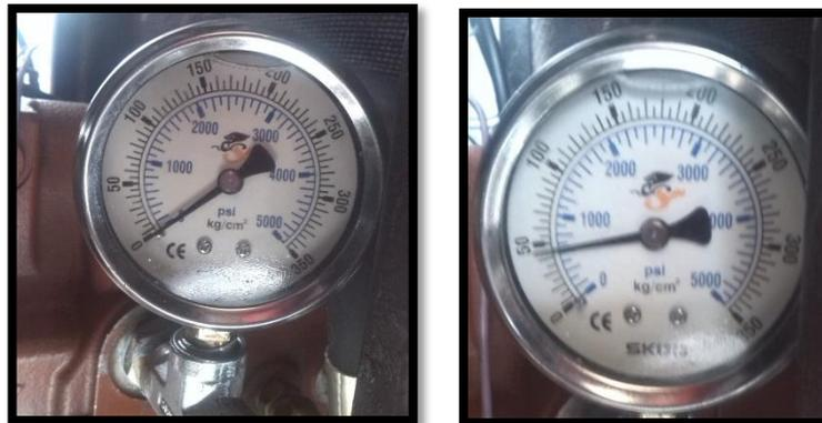
**Figura 5.9: Monitoreo de presión sistema hidráulico tractor**
