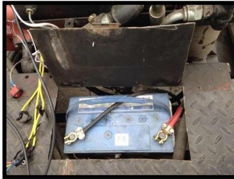
**Figura 4.4 Tapa metálica de la batería.**
