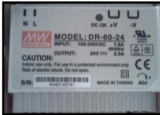
Figura 3.12 Fuente de voltaje 110/ 24v
