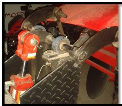
**Figura 2.5: Sistema hidráulico de levante de tres puntos.**
