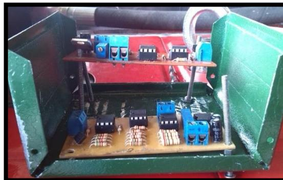
**Figura 4.11 Caja de circuitos electrónicos (sensores de nivel).**
