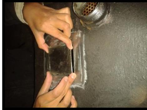
**Figura 4.2. Implementación de la base del sensor de nivel aceite hidráulico.**
