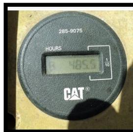
**Figura 2.14: Horómetro**
