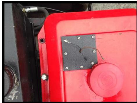
**Figura 4.3 Implementación de la base del sensor de nivel de combustible.**
