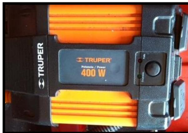
**Figura 3.11 Inversor de corriente**
