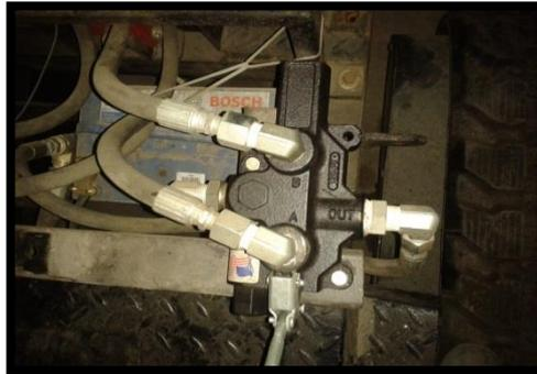
**Figura 2.3: Trasmisión hidráulica.**
