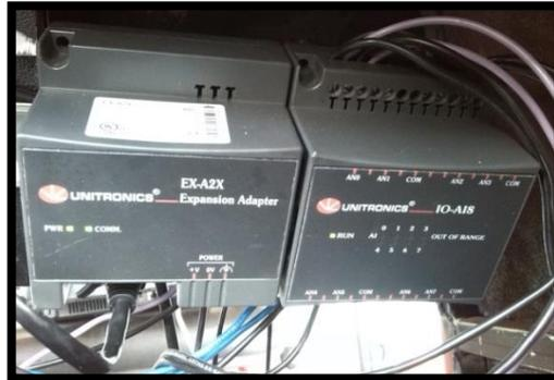
**Figura 4.31: Módulo de expansión de I/O analógicas**
