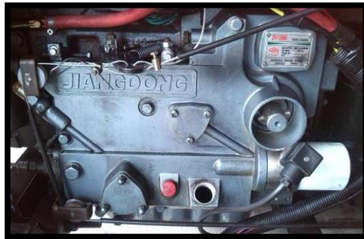
**Figura 4.17 Mecanismo del pedal de aceleración y apagado.**
