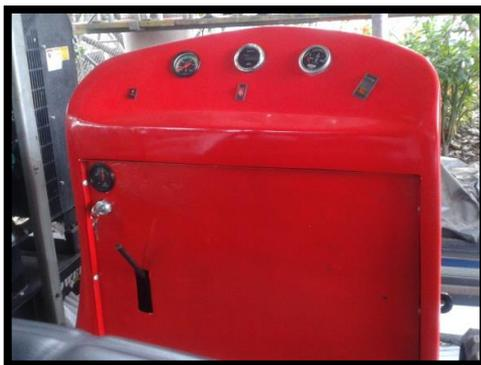
**Figura 2.1: Tablero inicial del Tractor agrícola monoplaza a diésel.**
