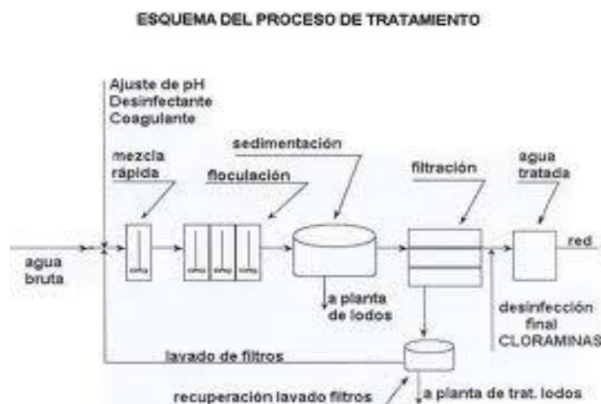
Figura 2.21. Proceso de tratamiento
