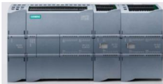
Figura 1.5. PLC S7-1200 con sus respectivos módulos de expansión
