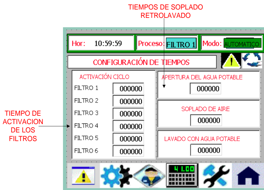
Figura 3.27. Ventanas de configuraciones
