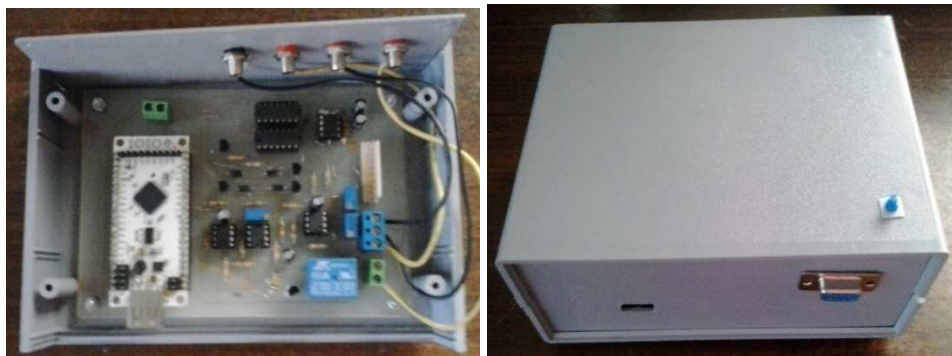
Figura 61: Montaje del Prototipo en Caja de Presentación
