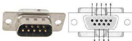
Figura 42: Conector DB-9 hembra del sensor Nellcor
