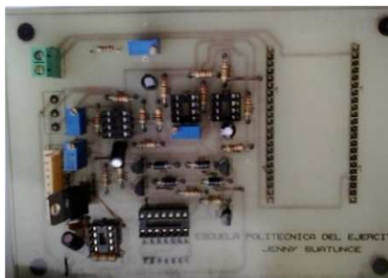
Figura 59: Montaje de elementos en placa de fibra de vidrio
