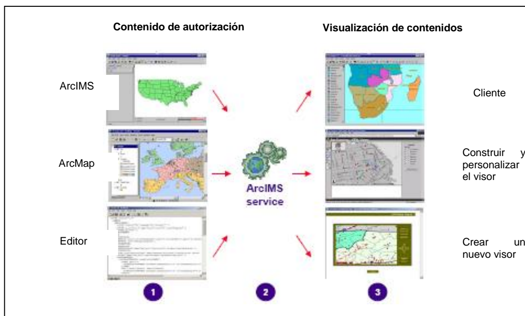
Figura 5.1. Proceso de creación de un sitio Web ArcIMS
