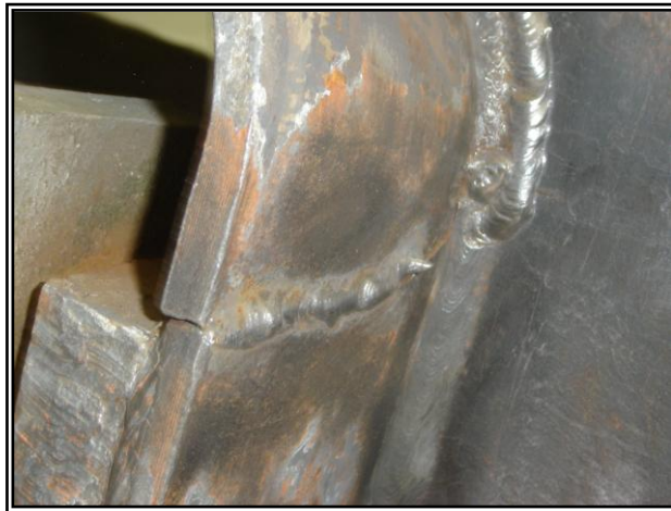
Limpieza del conjunto soldado para aplicar tintas penetrantes y verificar si existen defectos en los cordones de suelda
