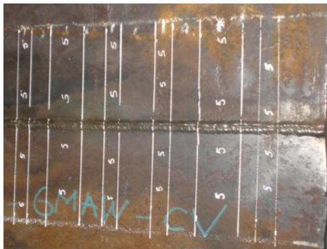
Figura 2.15: Cupón para calificación de un WPS, proceso GMAW en placa
