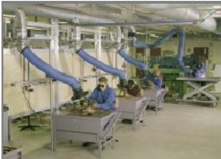
Figura 6.2: Extracción localizada en procesos de soldadura (múltiple)
