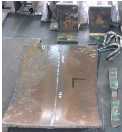
Figura 2.16: Probetas para ensayos en tubería (ranura) y placa (filete y ranura)
