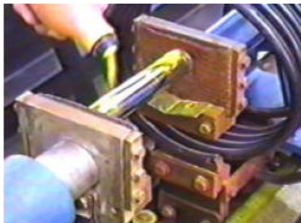
Figura 2.11: Técnica de magnetizado circular, se puede ver poniendo el polvo magnético seco para la inspección
