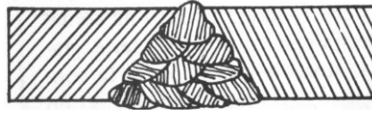
Figura 56: Método de cordones en serie
