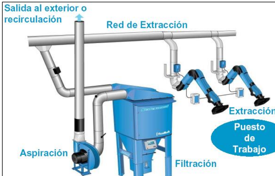
Figura 6.7 Concepto de Instalación Centralizada
