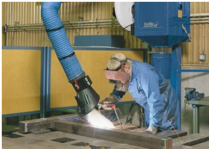
Figura 6.6: Extracción localizada de bajo vacío en soldadura
