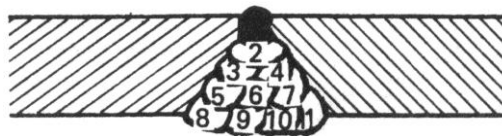
Figura 24: Relleno de bisel con cordones en serie
