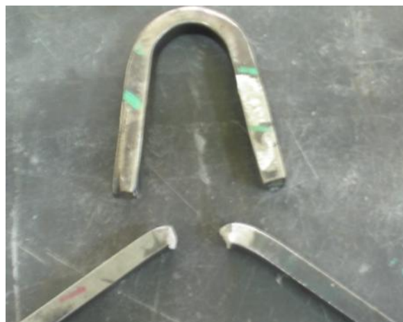
Figura 2.17: Pruebas destructivas, de arriba hacia abajo: prueba de doblez lateral en filete y ranura.
