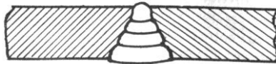
Figura 21: Unión de piezas situadas en el plano horizontal, con bordes enfrentados y bisel de 30^\circ
