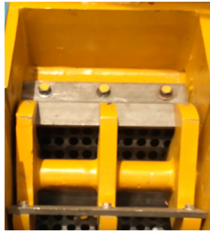
Figura 4.1 Cámara de molienda y sistema de cuchillas.
