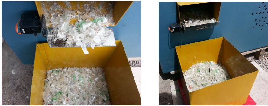
Figura 4.9 Accionamiento de la compuerta en dos posiciones de giro del servomotor.
