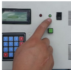
Figura 4.18 Led indicador de presencia de tolva de alimentación.
