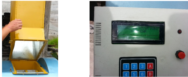
Figura 4.4 Tolva de alimentación y control de presencia.
