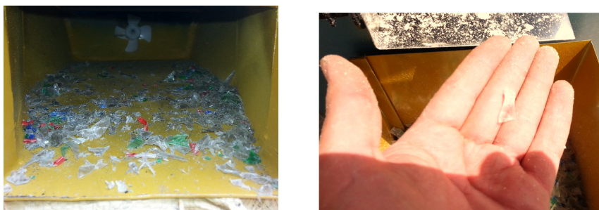
Figura 4.2 Tolva de descarga y tamaño final de las partículas de PET triturado.
