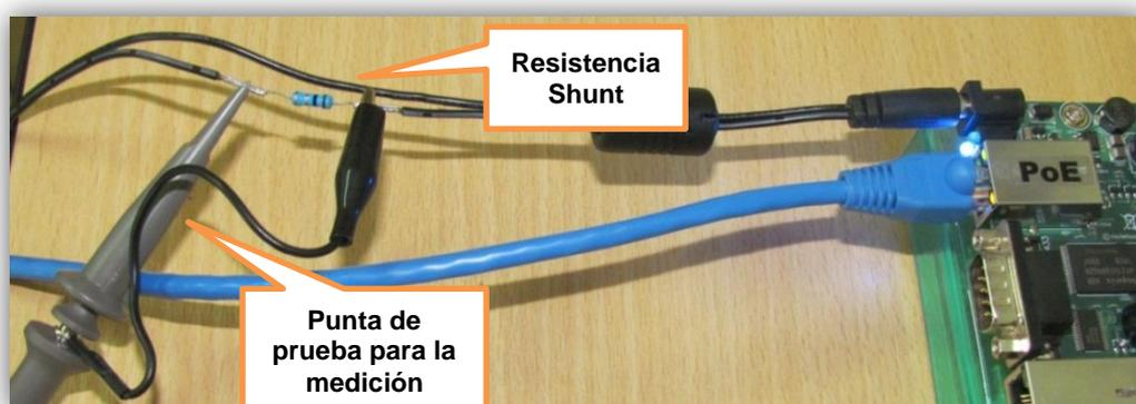
**Figura 23.** Medición indirecta de la corriente en la resistencia serie
