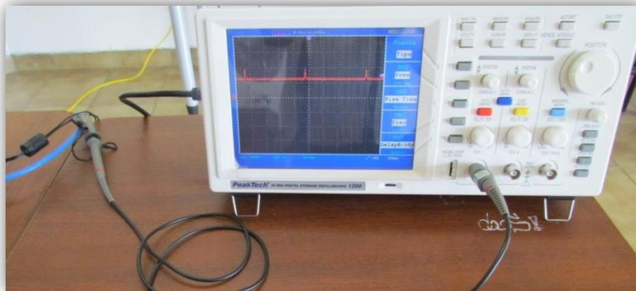
**Figura 25.** Señal de corriente en el dispositivo transmisor en modo de reposo
