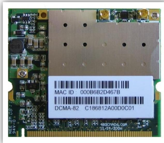
**Figura 10.** Módulo de Radio Wi-Fi DCMA-82
