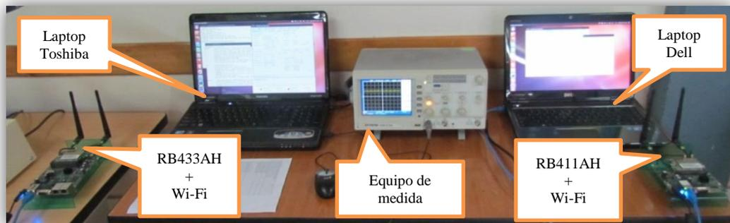
**Figura 20.** Enlace armado en el laboratorio entre el transmisor y receptor
