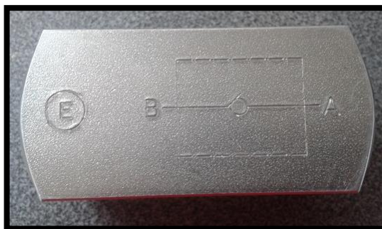
Figura 2. 18. Válvula de control de caudal Fuente: Autores.
