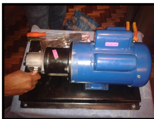
Figura 3. 27. Conjunto bomba, matrimonio y motor eléctrico Fuente: Autores.
