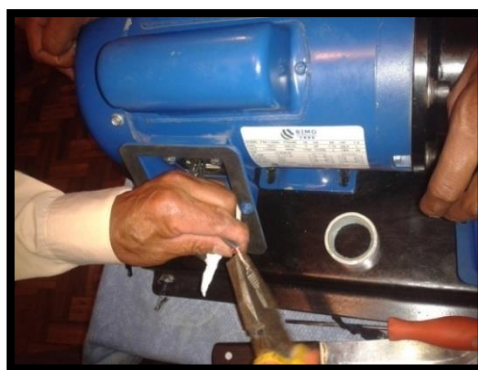
Figura 4. 32. Conexión a 110 v del motor eléctrico.
