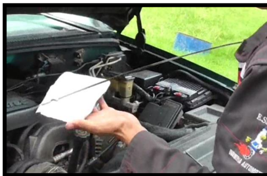
Figura 4. 66.Verificación del nivel de fluido.
