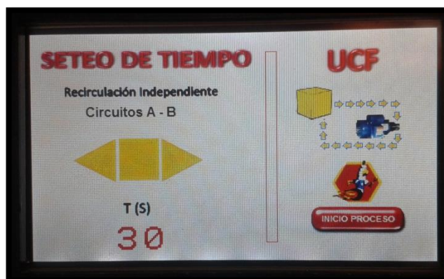
Figura 4. 52. Tiempo de recirculación o seteo. Fuente: Autores
