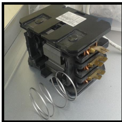
Figura 3. 59. Contactor Fuente: Autores
