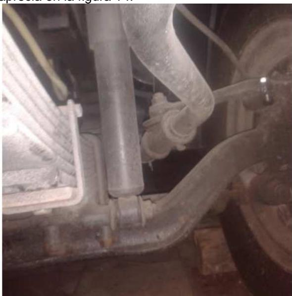
Figura 13 Interferencia acoplador y suspensión.
