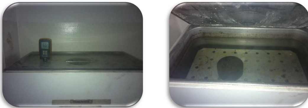
Fig. 60: Briqueta sumergida a 60°C.
