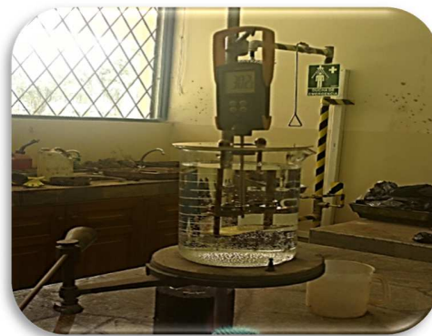
Fig. 41: Incremento de la temperatura del agua a razón de 5^{\circ}\text{C}/\text{min} .
