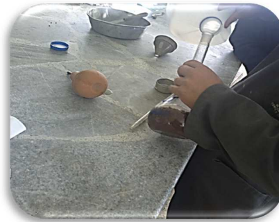
Fig. 32: Picnómetro con muestra de árido fino y agua destilada hasta la marca.
