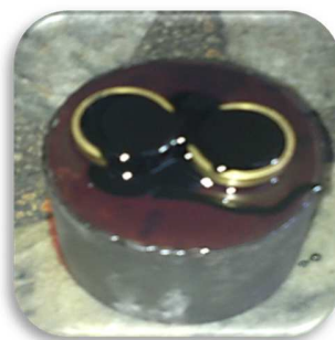
Fig. 39: Llenado del ligante asfáltico en los anillos.
