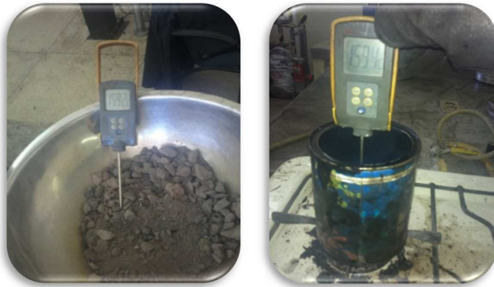
Fig. 64: Control de temperaturas de mezcla adicionando limadura metálica.
