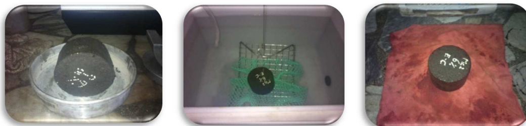
Fig. 67: Briqueta pesada en el aire, saturada superficie seca y sumergida.
