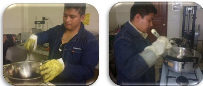
Fig. 52: Mezcla de agregados con ligante asfáltico.
