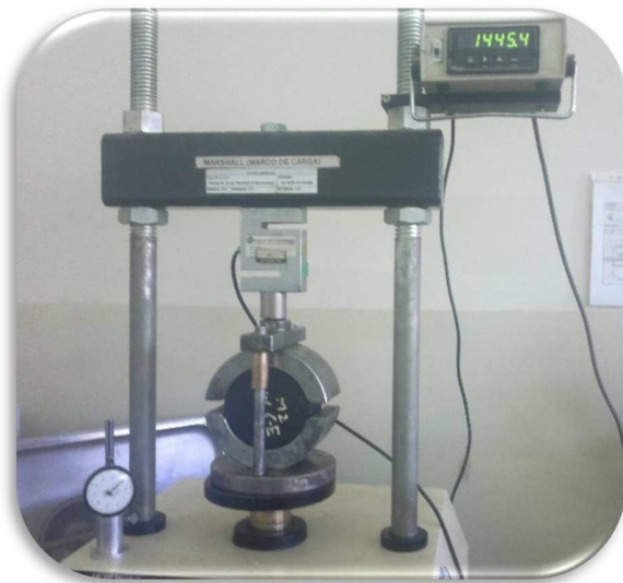
Fig. 61: Ensayo Marshall de estabilidad – flujo.
