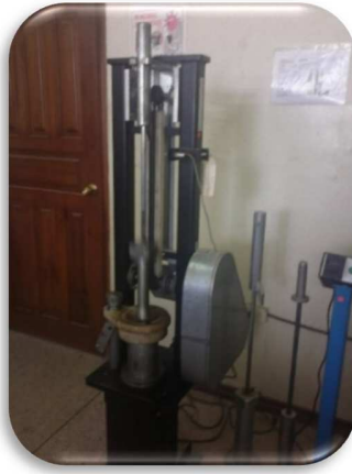
Fig. 55: Compactación de briquetas Marshall.
