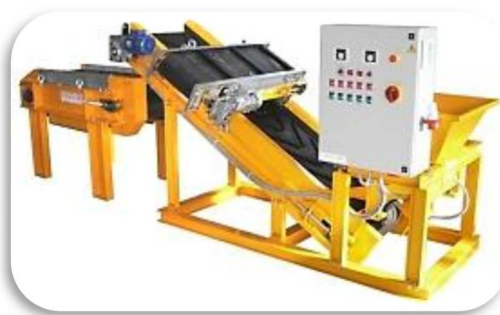
Fig. 10: Separador magnético Fuente: (VIVO EN ITALIA, 2009)
