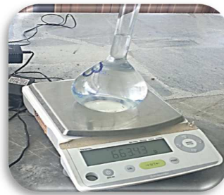
Fig. 30: Peso del picnómetro con agua hasta la marca.
