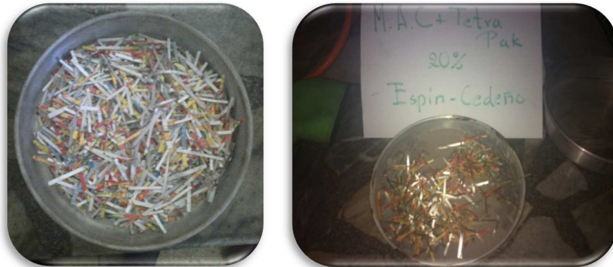
Fig. 66: Fibras tetra pak adicionada al mix de agregados.
