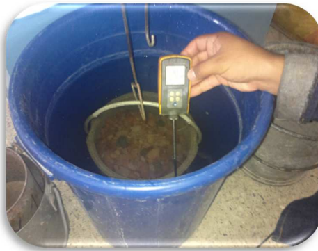
Fig. 25: Canasta con agregado grueso sumergido en agua.
