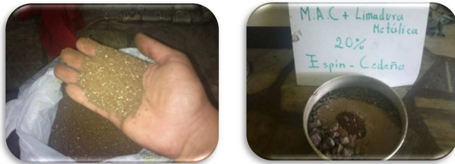
Fig. 63: Limadura metálica adicionada al mix de agregados.
