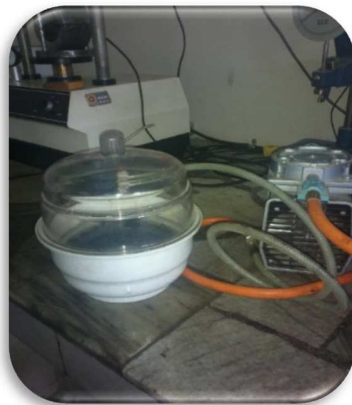
Fig. 59: Extracción del aire de la mezcla asfáltica en el ensayo RICE.
