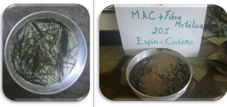
Fig. 65: Alambre metálico de neumáticos fuera de uso adicionada al mix de agregados.
