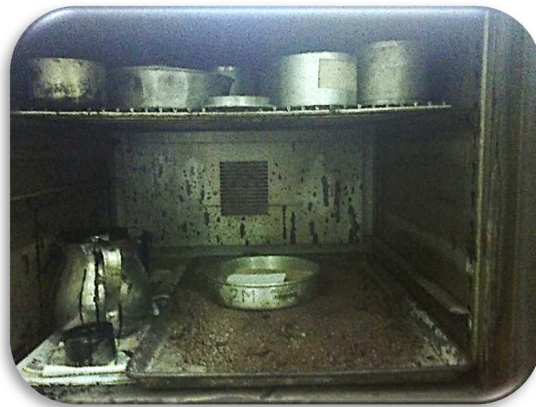
Fig. 53: Moldes precalentados en horno.
