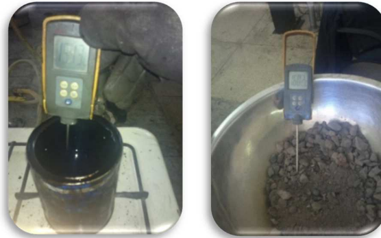
Fig. 51: Control de temperaturas de mezcla.
