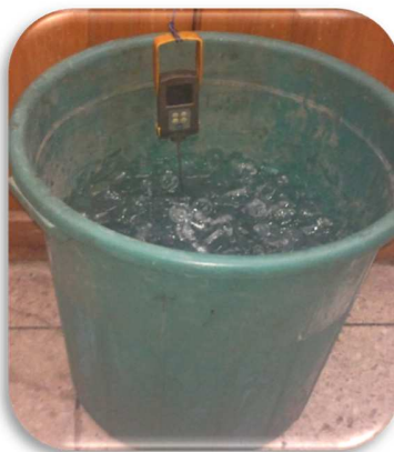
Fig. 69: Briquetas sometidas en agua a 0 °C durante 10 minutos
