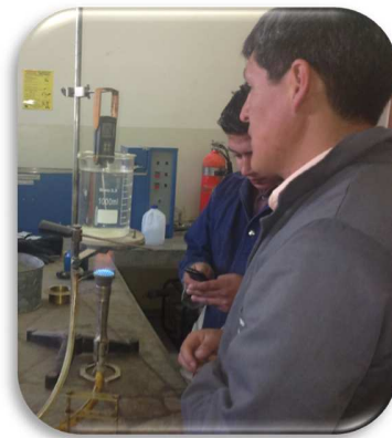
Fig. 40: Estabilización de la temperatura del agua.
