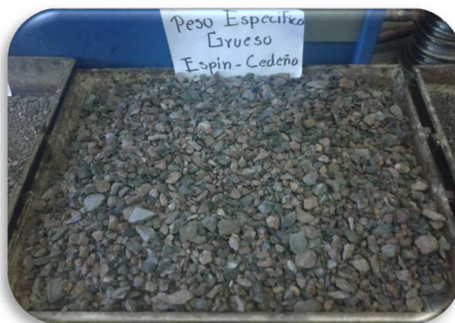
Fig. 26: Lavado y secado del agregado grueso.
