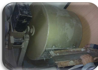
Fig. 36: Máquina de los ángeles con el material y las esferas.
