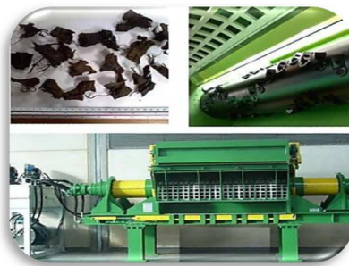
Fig. 8: Trituradora secundaria Fuente: (VIVO EN ITALIA, 2009)
