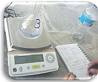
Fig. 29: Peso del picnómetro sin agua destilada.
