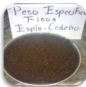
Fig. 28: Agregado fino sumergido en agua.
