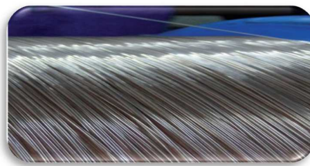
Fig. 3: Alambres de llanta durante su producción. Fuente: (EMCOCABLES, 2014)
