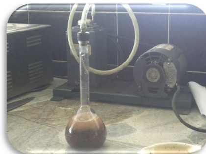
Fig. 33: Extrayendo burbujas de aire del picnómetro con la muestra.
