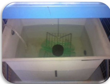
Fig. 57: Briqueta sumergida en agua a 25 °C.
