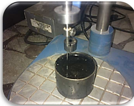
Fig. 45: Penetración de la aguja en la superficie de la muestra.
