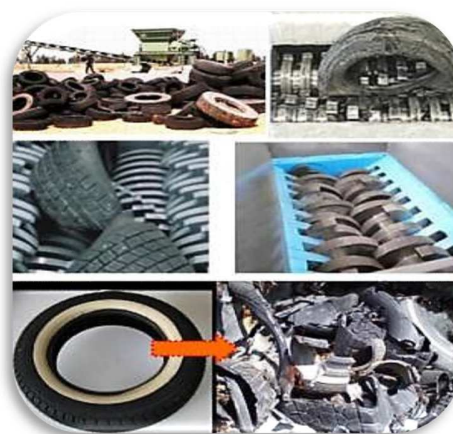
Fig. 7: Trituradora primaria Fuente: (VIVO EN ITALIA, 2009)
