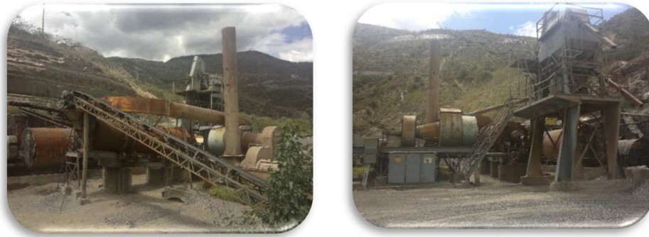
Fig. 75: Bandas transportadoras y tambor secador de áridos.
