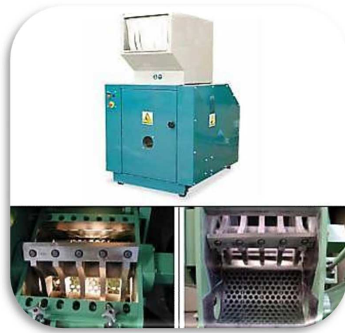
Fig. 11: Granulador secundario Fuente: (VIVO EN ITALIA, 2009)
