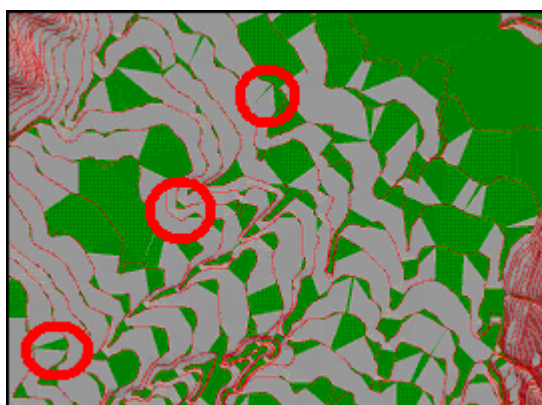
Fig. 11.- Problemas presentados por el método de triangulación
