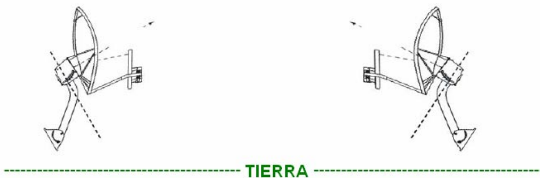
Figura 3. Posicionamiento incorrecto de la antena del sistema CANOPY
