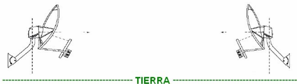
Figura 4. Posicionamiento correcto de la antena del sistema CANOPY
