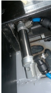
Figura 4.38 Montaje del los cilindros neumáticos del pisador.
