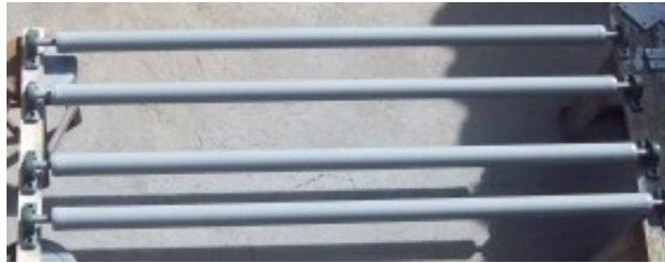
Figura 4.15 Pintura de rodillos guías.
