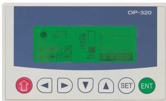
Figura 3.8 Panel operador OP-320 XINJE.
