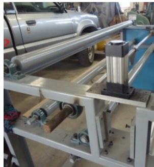
Figura 4.37 Montaje de los cilindros neumáticos del rodillo presor.
