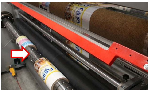
Figura 2.2 Sujeción y desbobinado por ejes neumáticos expansibles.
