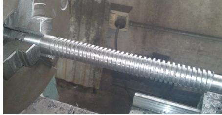
Figura 4.9 Mecanizado del tornillo.
