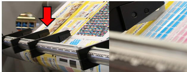
Figura 2.11 Sistema de corte por cuchillas planas.
