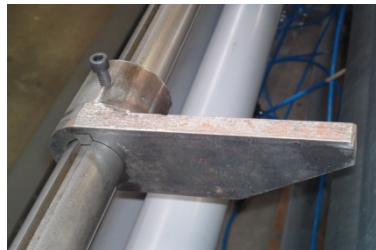
Figura 4.18 Montaje de los portacuchillas.
