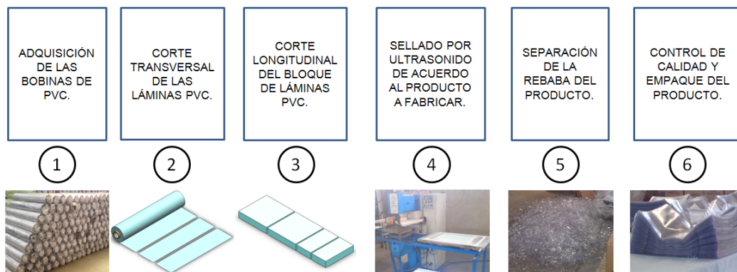
Figura 1.2 Etapas de fabricación de productos en film PVC.
