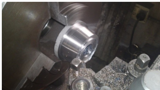
Figura 4.8 Construcción del cono del mecanismo B.
