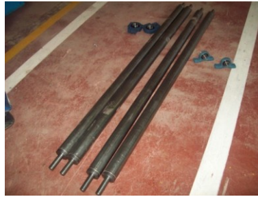
Figura 4.14 Rodillos guía terminados.
