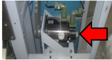
Figura 4.45 Montaje del servo motor.
