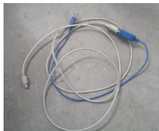
Figura 4.62 Cable de programación PLC - PC.
