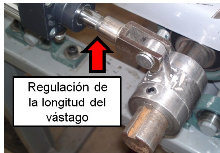
Figura 5.5 Regulación de la longitud del vástago.
