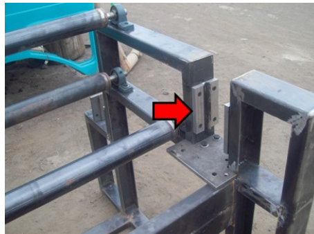
Figura 4.22 Montaje de las guías T.
