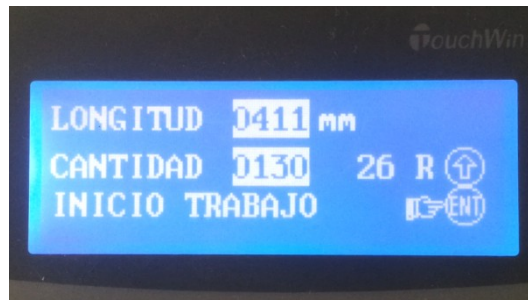
Figura 5.17 Verificación del funcionamiento del OP-320.
