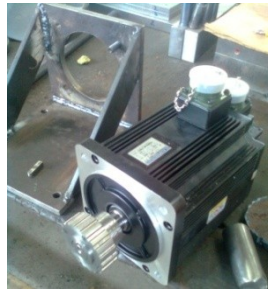
Figura 4.23 Construcción de la base del servo motor.
