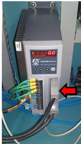
Figura 5.14 Cable de comunicación PLC - servo drive.
