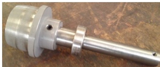
Figura 4.5 Montaje del cono y el eje del mecanismo A.
