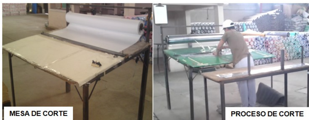
Figura 1.3 Corte transversal de las láminas PVC.
