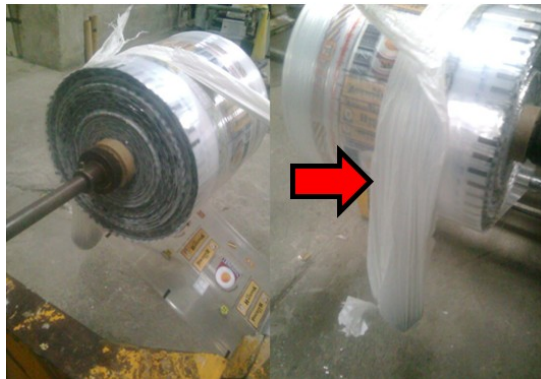
Figura 2.7 Sistema de frenado por contrapesos.
