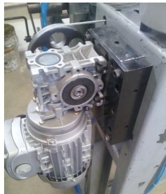
Figura 4.31 Montaje del ensamble motorreductor.
