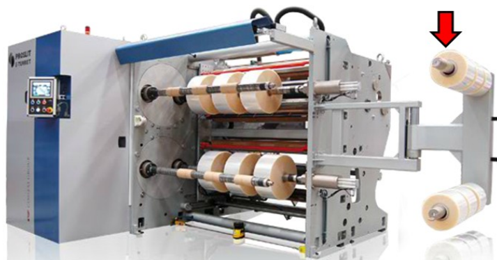
Figura 2.4 Sistema de sujeción y desbobinado por ejes en voladizo.
