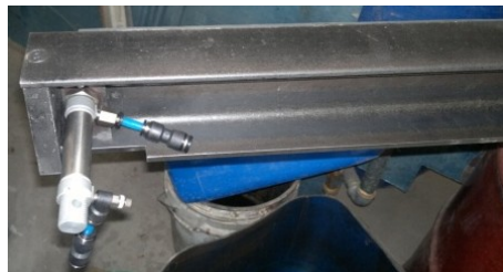
Figura 4.24 Construcción de mesa de fijación.
