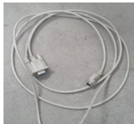
Figura 5.13 Cable de conexión PLC - Panel de operación.
