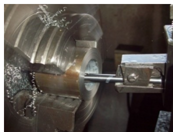
Figura 4.16 Construcción de la primera parte del portacuchillas.
