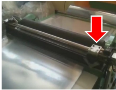
Figura 2.17 Sistema de corte por cuchilla con filo tipo V.
