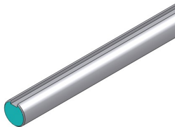
Figura 2.66 Detalle de ranura en el eje portacuchillas.
