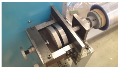
Figura 4.11 Montaje del sistema de frenado.
