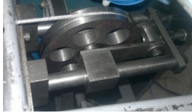
Figura 4.32 Montaje del mecanismo tensor.
