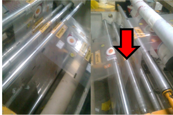
Figura 2.8 Sistema de guiado mediante rodillos.
