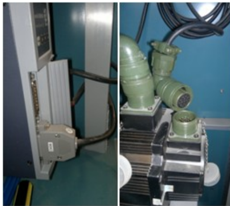
Figura 4.49 Cable de conexión servo drive - encoder del servo motor.
