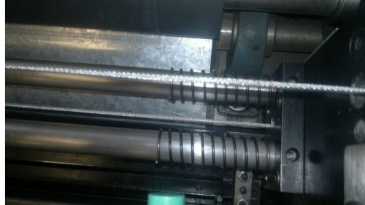
Figura 4.30 Montaje de la guía lineal.
