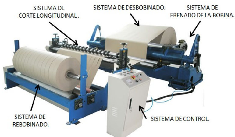
Figura 1.5 Máquina cortadora rebobinadora.
