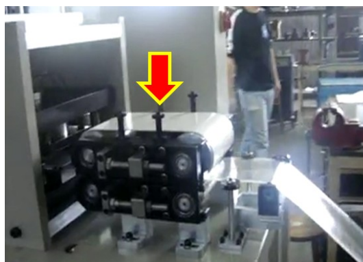
Figura 2.10 Sistema de arrastre mediante bandas transportadoras.
