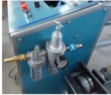
Figura 4.34 Montaje de la unida de mantenimiento.
