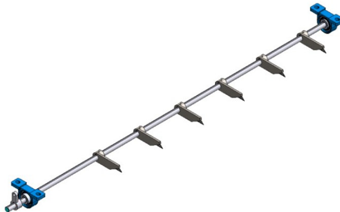
Figura 2.67 Ensamble - sistema de corte longitudinal.
