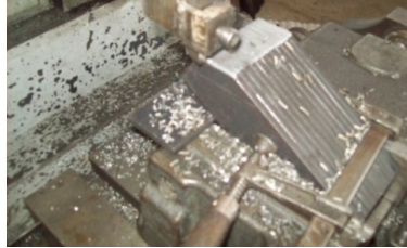
Figura 4.17 Construcción de las bases de los portacuchillas.
