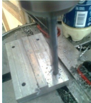
Figura 4.21 Construcción de las guías T.
