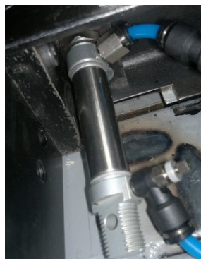
Figura 4.27 Acoplamiento entre la mesa de fijación y el pisador.
