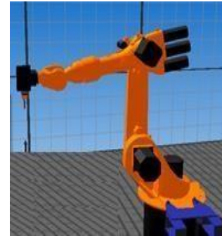
Fig. 6: Robot industrial KUKA KR16 con cabezal fresador adaptado en el KUKA Sim Pro.
