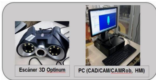
Fig. 10: Dispositivos pertenecientes a la celda de manufactura.
