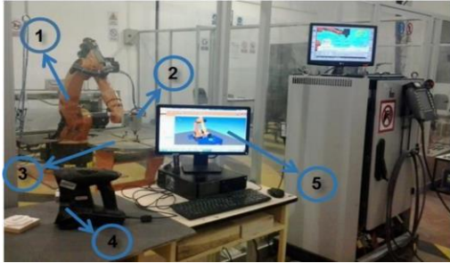
Fig. 9: Celda de manufactura robotizada. Brazo robótico industrial KUKA KR16 (1). Cabezal fresador Jäger (2). Mesa de trabajo (3). Escáner 3D (4). PC (5).
