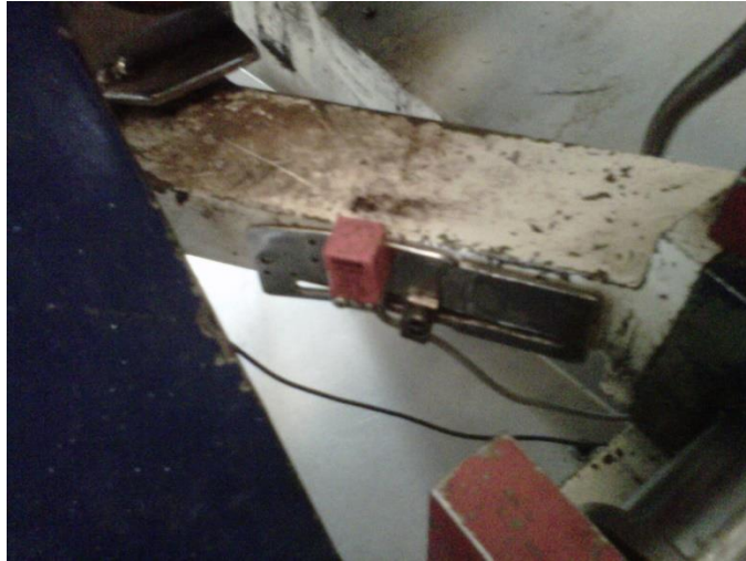
Figura 3.32. Montaje de los sensores inductivos para la apertura y cierre del molde.
