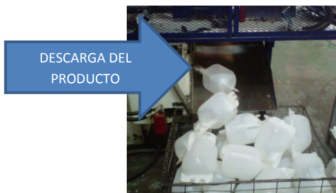
Figura 3.5. Sentido actual de la bandeja de descarga.
