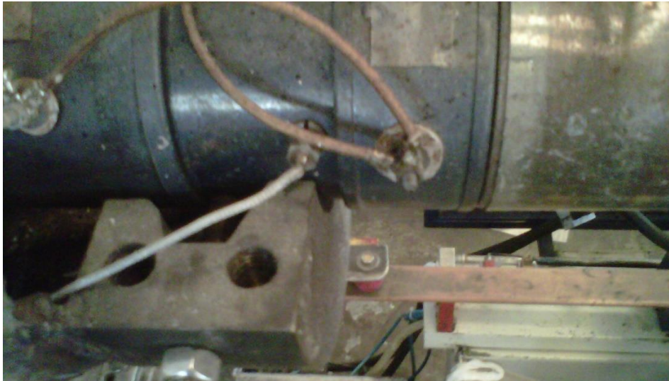
Figura 3.30. Montaje de las termocuplas.
