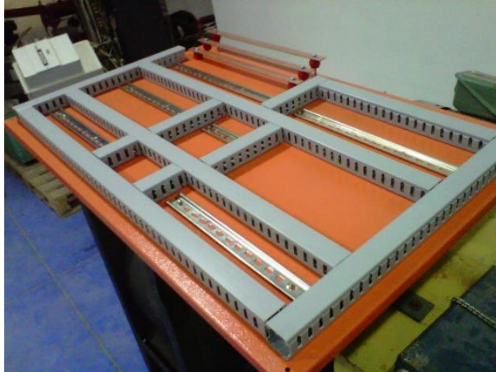
Figura 3.19. Distribución de rieles din y canaletas.
