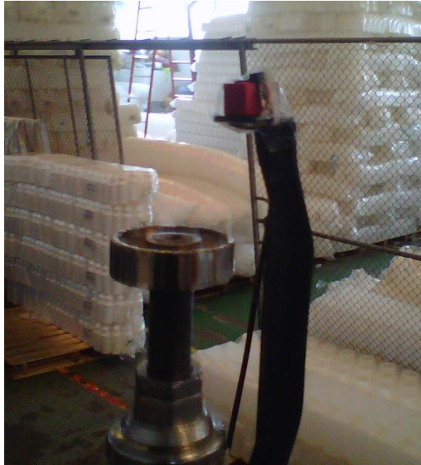
Figura 3.34. Montaje del sensor del pin de soplado.
