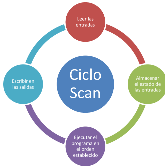
Figura 1.24. Diagrama de Bloques de funcionamiento del PLC.
