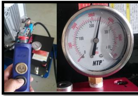
Figura 4. 45: Accionamiento del descenso y presión del manómetro
