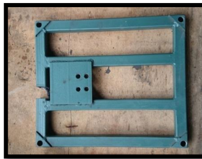
Figura 4. 18: Bases de soporte de Las celdas de carga
