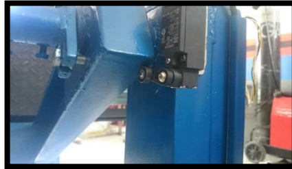
Figura 4. 35: Instalación final de carrera
