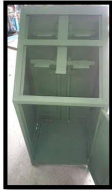
Figura 4. 31: Caja de mando construcción preliminar
