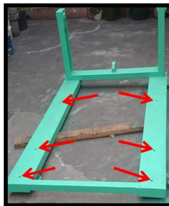
Figura 4. 14: Perforaciones para la sujeción de plataformas
