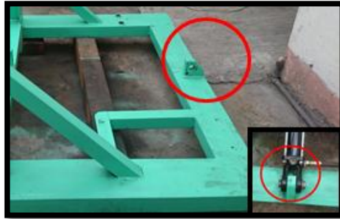
Figura 4. 5: Puntos de soporte de actuador hidráulico
