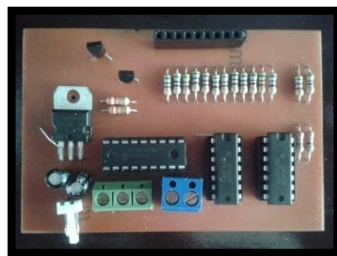
Figura 4. 24: Circuito principal de indicador de giro angular
