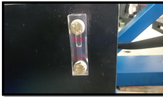
Figura 4. 29: Mirilla reservorio hidráulico
