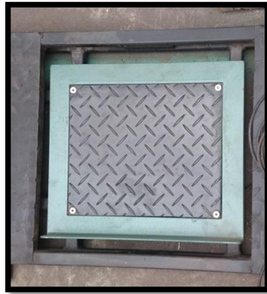
Figura 4. 23: Ensamblaje entre estructura de plataforma y conjunto de celda de carga
