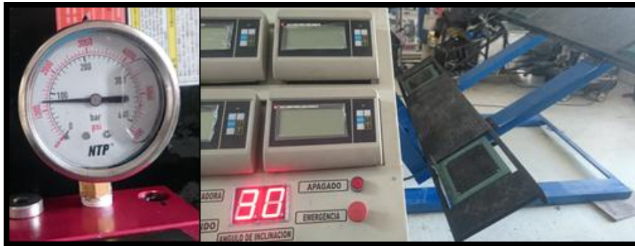
Figura 4. 43: Indicador angular y manómetro en ascenso
