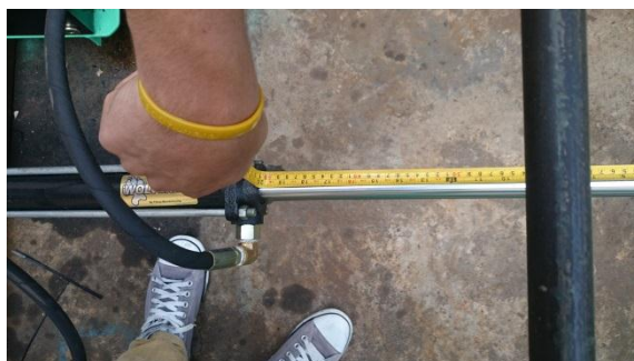
Figura 3. 31: Longitud de carrera del pistón
