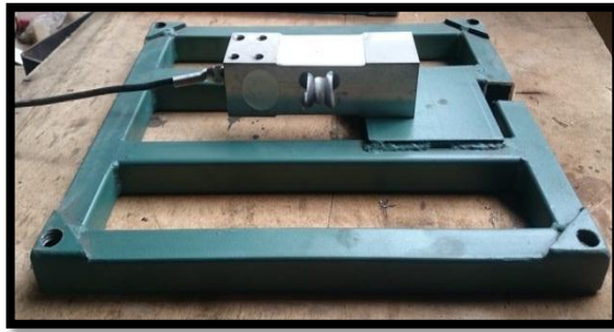
Figura 4. 19: Ensamblaje entre soporte y celda de carga
