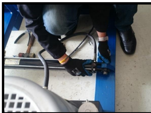
Figura 4. 26: Ensamblaje entre estructura móvil y actuador hidráulico
