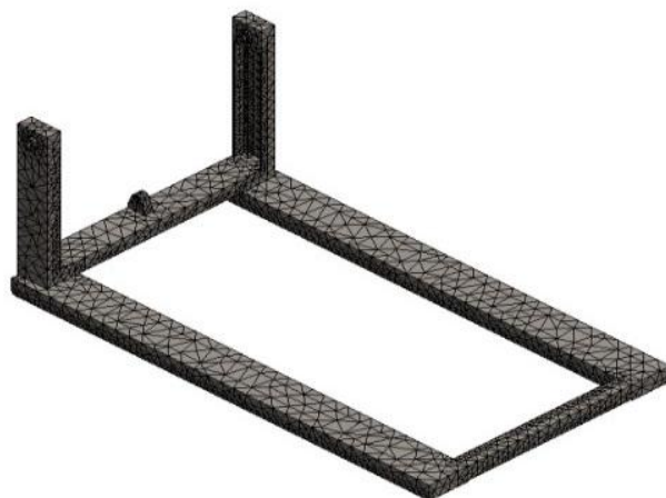
Figura 3. 8 Malla brazo de elevación
