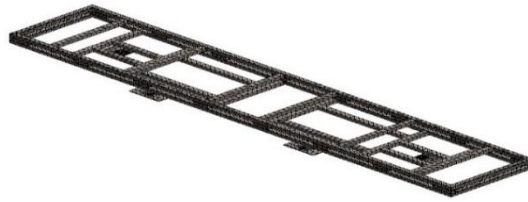
Figura 3. 12: Representación de malla de la plataforma de elevación
