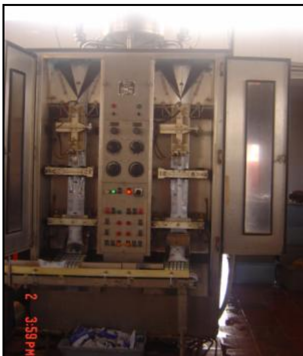
FIG3.10. MÁQUINA PREPAC. ENFUNDADORA DEL PRODUCTO.
