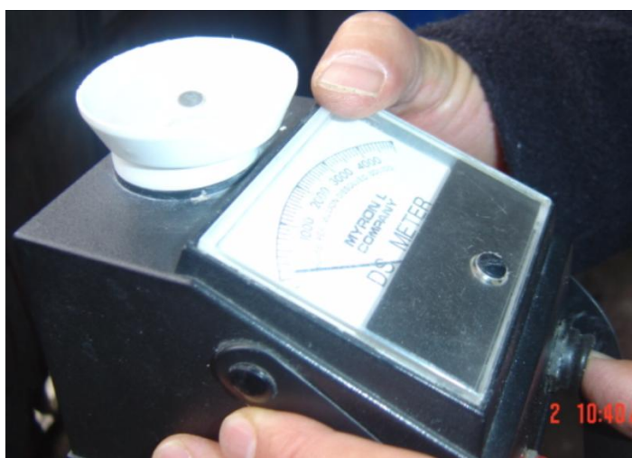
FIG4.8. SD METER PARA LA MEDICIÓN DE SÓLIDOS DISUELTOS EN EL AGUA DE CALDERA, AGUA DE ALIMENTACIÓN, AGUA DE REPOSICIÓN Y CONDENSADO.
